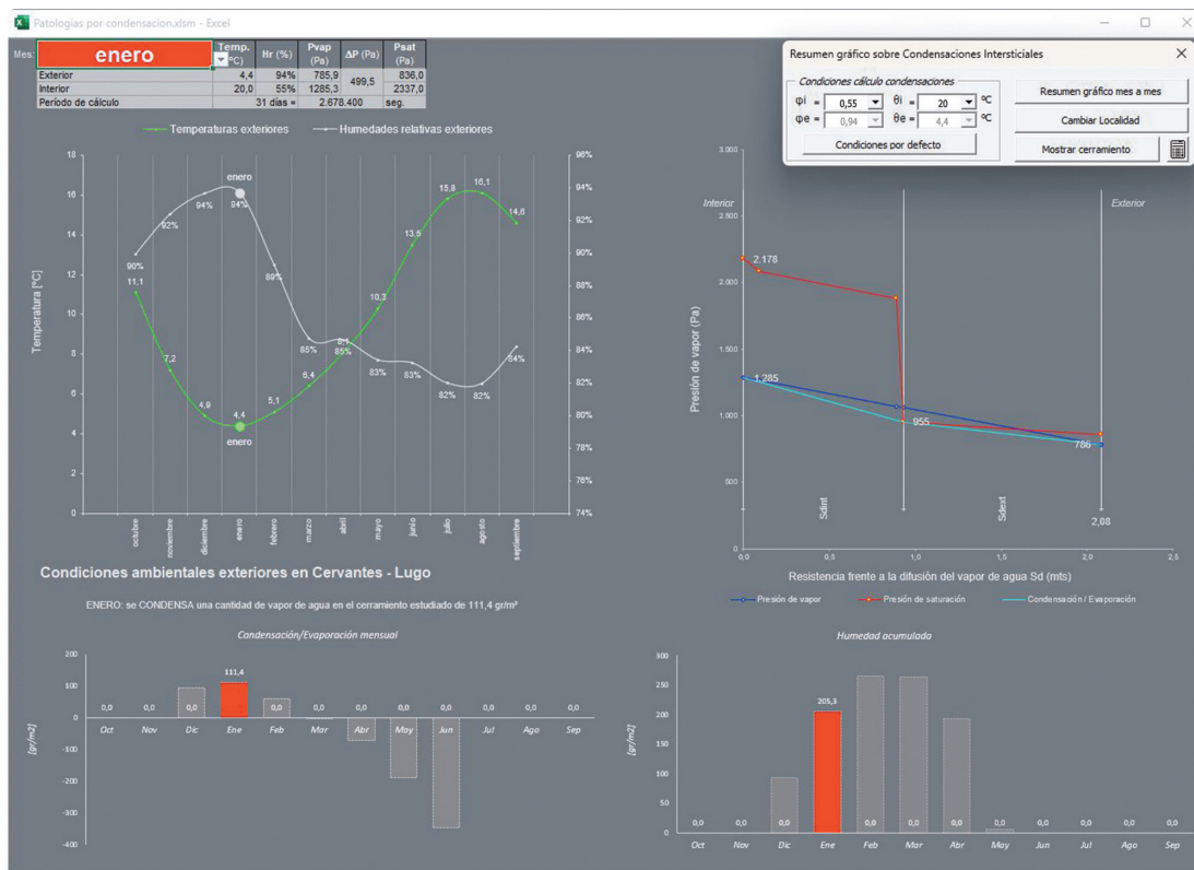
Imagen 139. Condensación/evaporación UNE EN ISO 13788:2001.
