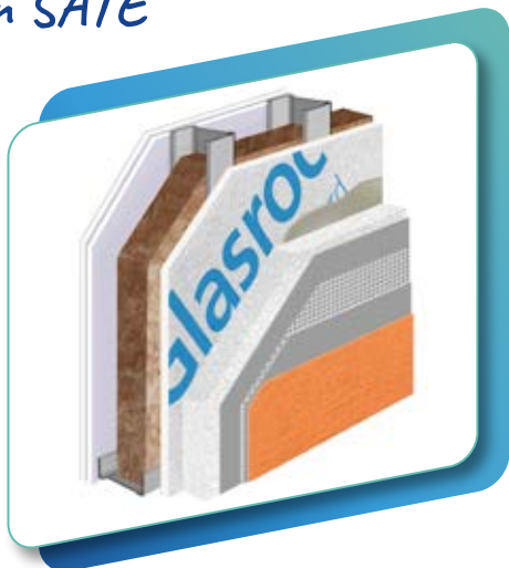
Muro exterior de hoja simple con SATE
