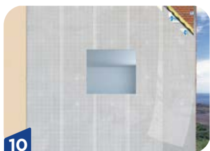
10 Instalación de Placotherm® Rollo de malla 160
