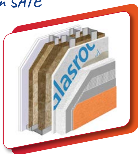
Muro exterior de hoja doble con SATE
