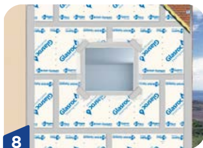
8 Refuerzo de esquinas de ventanas y puertas con rollo de malla
