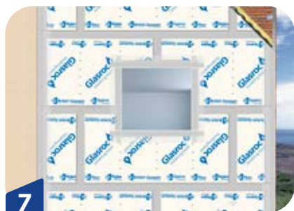
7 Refuerzo de puntos singulares con la gama de perfiles y el mortero
