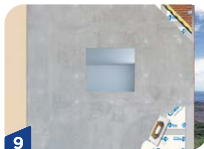
9 Aplicación de 1º capa de mortero con llana dentada
