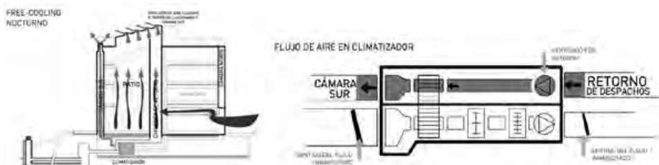
Figura 10. Estrategia de funcionamiento del free-cooling. Autor: Zeroaplus.
