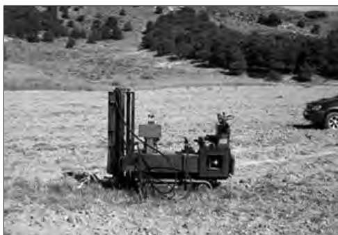
Figura 1. Equipo de penetración dinámica emplazado para la realización de una prueba.
