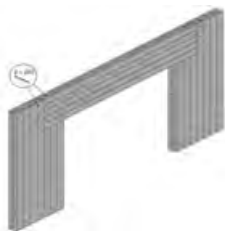
Figura 8. Ejemplo de cargadero integrado
