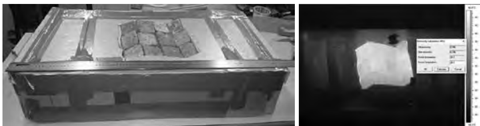
Figura 8 y 9: Experimento realizado para averiguar el valor de “ k ” del pavimento de la sala del caldarium .
