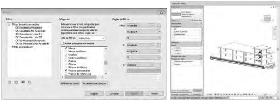
Figura 6. Filtros de visualización para los criterios de aceptación o rechazo (IZQ) y Visualización de una vista 3D filtrada según los parámetros de aceptación del Control de Calidad (DCHA).
