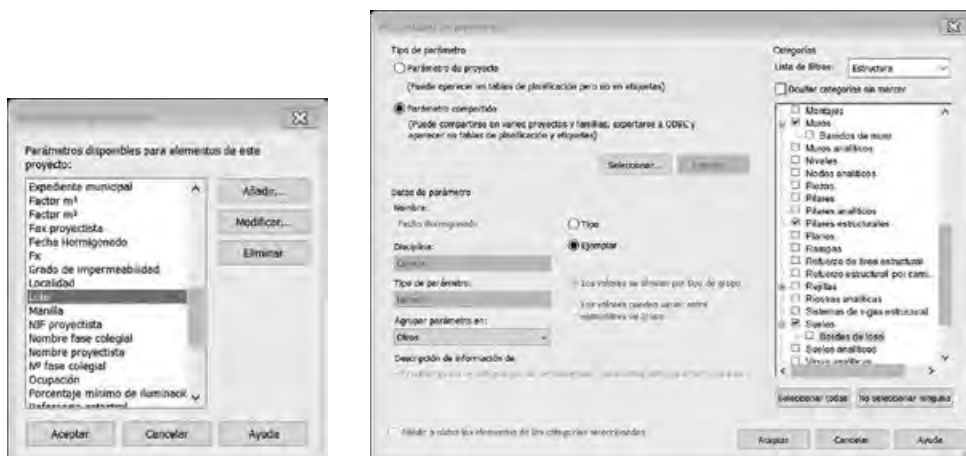
Figura 3. Autodesk Revit. Creación de parámetros de proyecto a partir de los parámetros compartidos.
