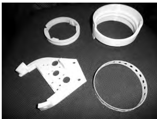
Figura 6. Impresión de varias piezas del segundo prototipo.
