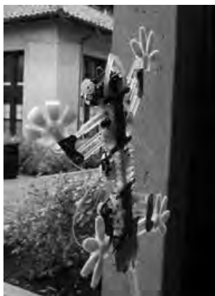
Figura 10: Robot con traslación con extremidades “tipo gecko”.
