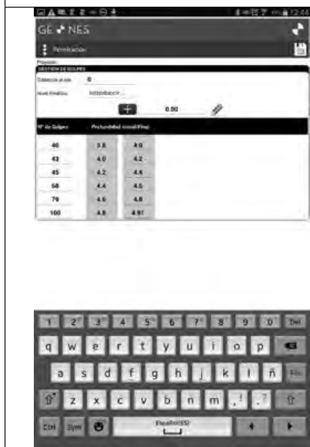
Figura 5. Toma de datos durante la prueba de penetración dinámica..
