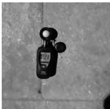
Figura 3. Luxómetro, para conocer el nivel de iluminación. (Fotografía propia)
