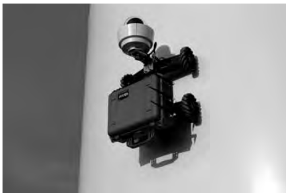
Figura 4: Robot con sustentación magnética con imanes de niobio en las ruedas.
