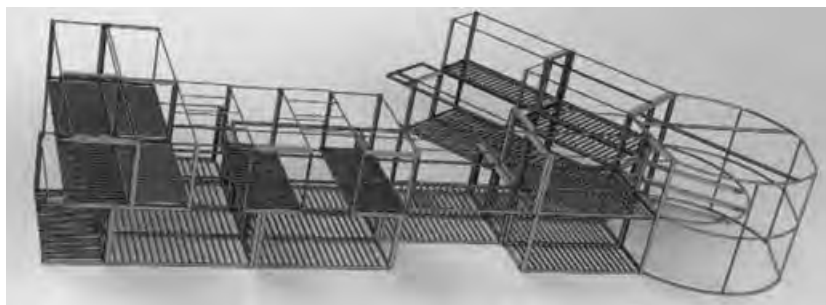
Figura 15. Esquema de la estructura metálica del edificio, basada principalmente en contenedores marítimos.
