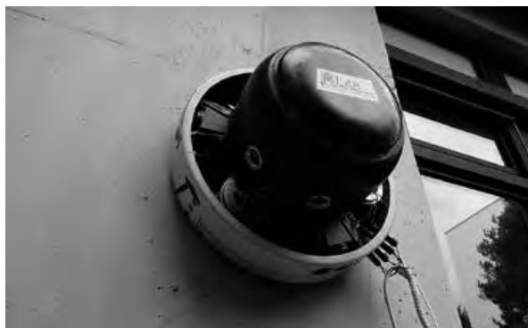
Figura 5: Robot con sustentación por presión negativa activa producida por varios motores de succión y traslación por ruedas.
