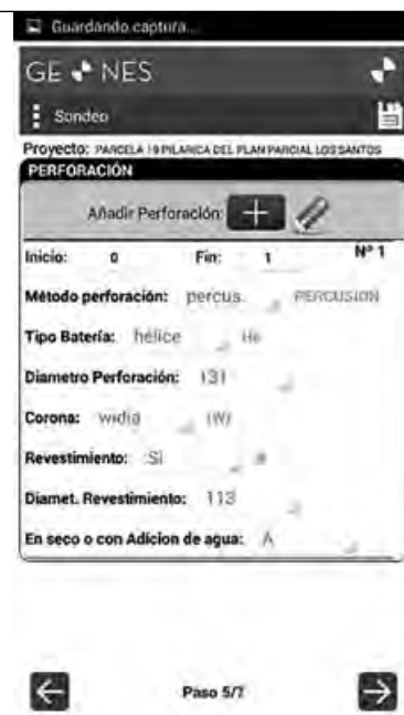
Figura 6. Introducción de datos de la perforación
