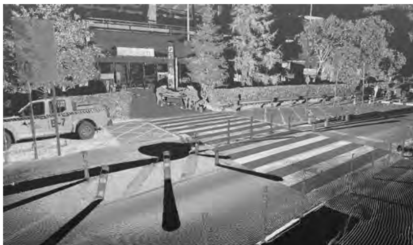
Figura 1: Nube de puntos del vial de acceso a T1 sin texturizar.
