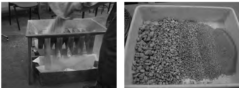
Figura 1 Cuarteo del árido reciclado, fotografías propias..
