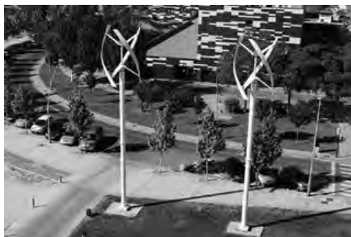
Figura 7. Aerogeneradores de eje vertical. Autor: Zeroaplus.
