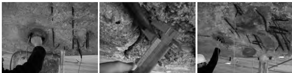
Figura 5. Corrosión generalizada.
