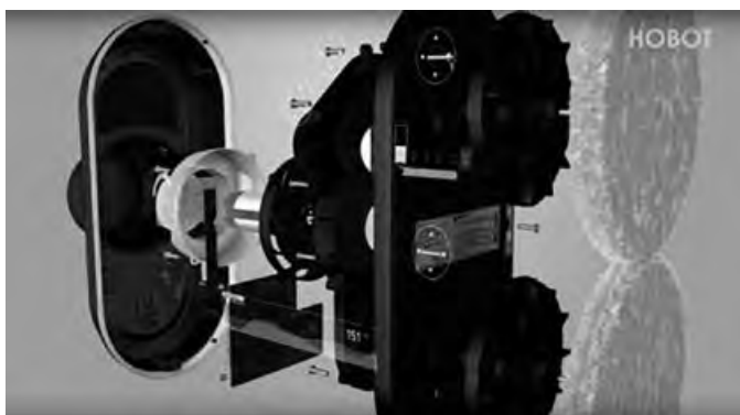
Figura 7: Robot comercial de limpieza de ventanas con sustentación por presión negativa activa producida por varios motores de succión.
