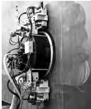
Figura 2: Robot de mantenimiento de cascos de barco mediante sustentación magnética y traslación por ruedas.
