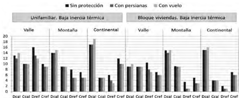
Figura 7. Demandas y cargas energéticas en función de las protecciones solares en cada climatología. Caso de baja inercia térmica.
