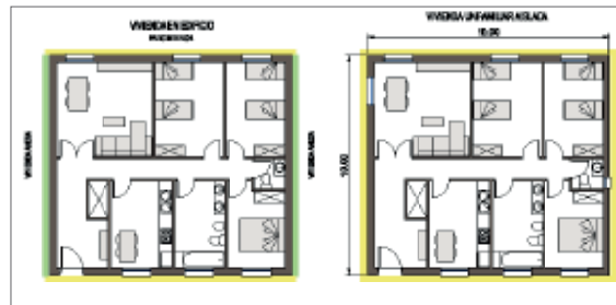
Figura 6. Afectación puentes térmicos en función de la tipología de vivienda.
