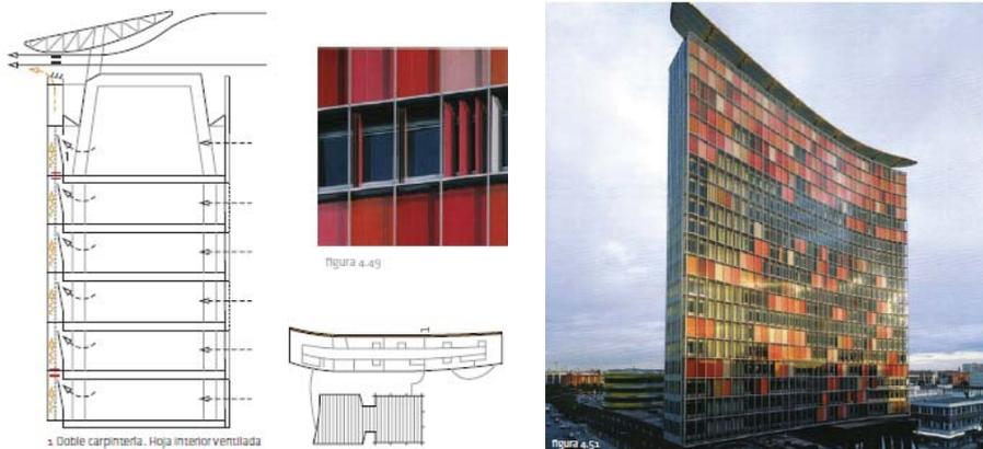
Figura 30. Sección y detalle del elemento venturi, detalle de la fachada e imagen exterior. Sede de la GSW.
