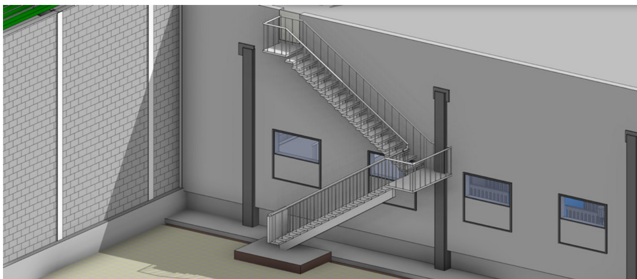
Figura 4.14. Escalera de acceso entre las cubiertas de la nueva nave y la existente y puerta de acceso con cierre y apertura remoto
