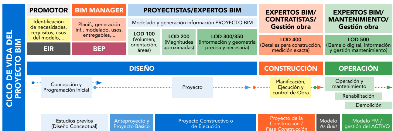
Figura 3.3. Evolución orientativa del nivel de desarrollo del modelo en un proyecto BIM y equivalencia con el tipo de proyecto
