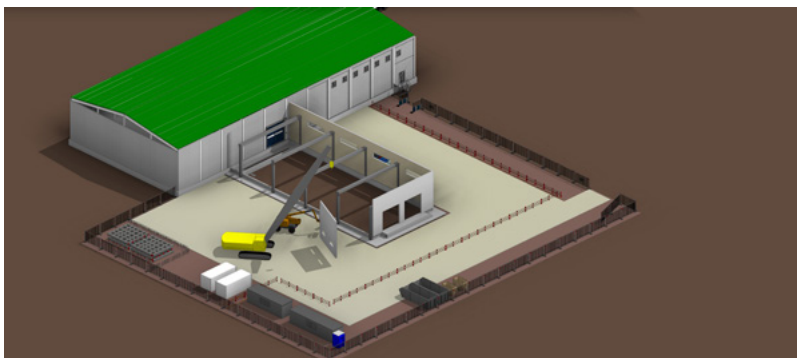
Figura 4.9. Fase de Montaje de placas alveolares (prelisa) para cubierta transitable: las placas alveolares integran sistemas provisionales de protección de borde (barandillas) que se colocan antes del izado para la fase de montaje. De esta forma el frente de trabajo está siempre protegido para los montadores en el momento de aproximación para el ajuste de las prelasas
