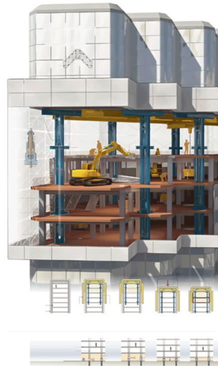
Figura 3.52. Comparación de métodos alternativos de demolición: equipos mecanizados con cizallas vs. sistema automatizado de demolición descendente
