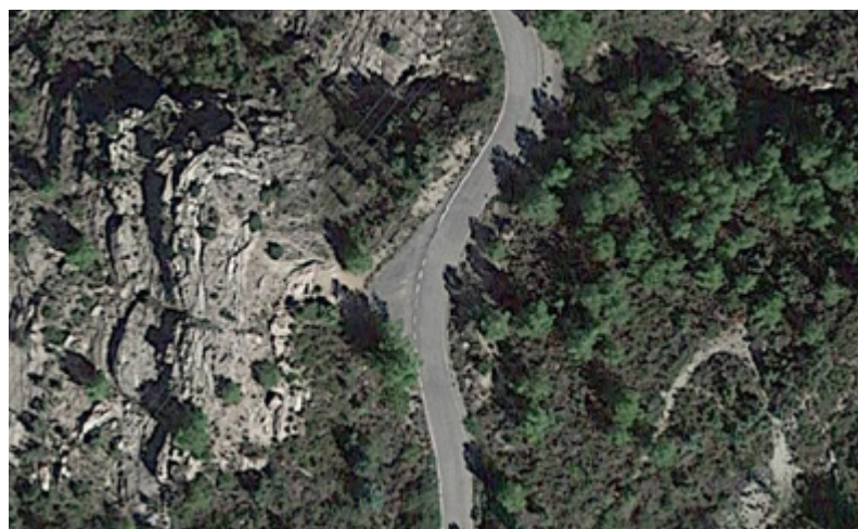
Figura 13. Apartaderos en caminos con ancho reducido situados en puntos con visibilidad. Tramo Bejís-Arteas de Abajo [Castellón]. Fuente: Google maps.
