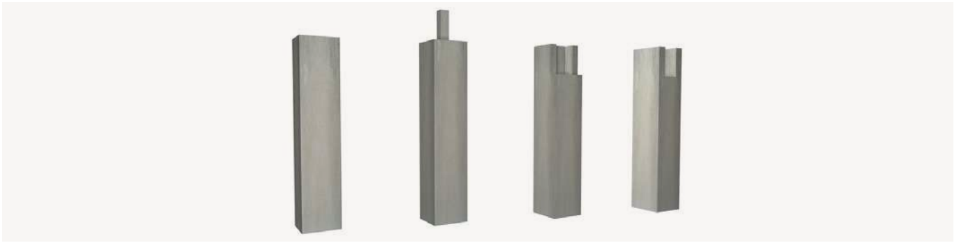
Fig 11. Diferentes tipos de pilares prefabricados de hormigón, y las uniones planteadas con las vigas también prefabricadas de hormigón.
