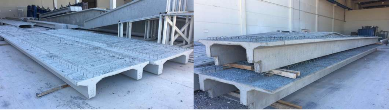
Fig 33. Ejemplos de placas alveolares y doble TT de hormigón prefabricado.
