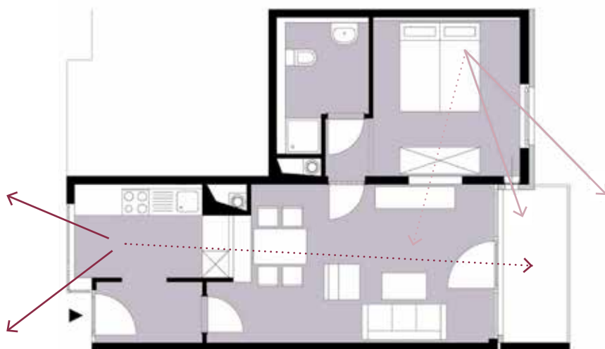
Planta de una de las tipologías de viviendas asistidas para mayores. Se destacan las relaciones visuales entre las diferentes piezas de la unidad (línea de puntos) y entre el interior y el exterior (línea continua). Fuente: Franziska Ullmann, con autorización.
