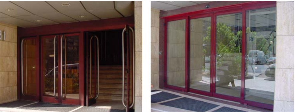
Sustitución en un portal de puertas manuales por puertas automáticas. Facilidad de manipulación y rapidez de apertura.
