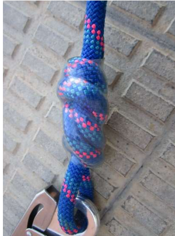
Fig. 5.7.4-6. Terminación en nudo de ocho.
