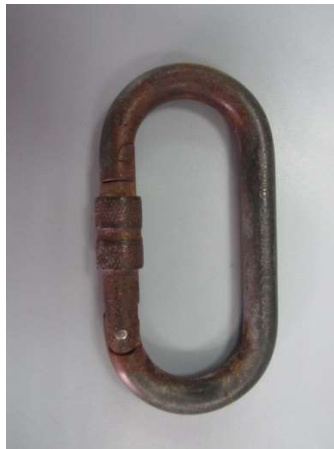
Fig. 5.3.2-1. Conector de acero oxidado.
