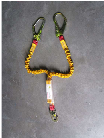
Fig 5.6.2-6. Doble amarre de cinta con absorbedor. Las cintas quedan recogidas por un elástico, pero en caso de caída se estiraría.
