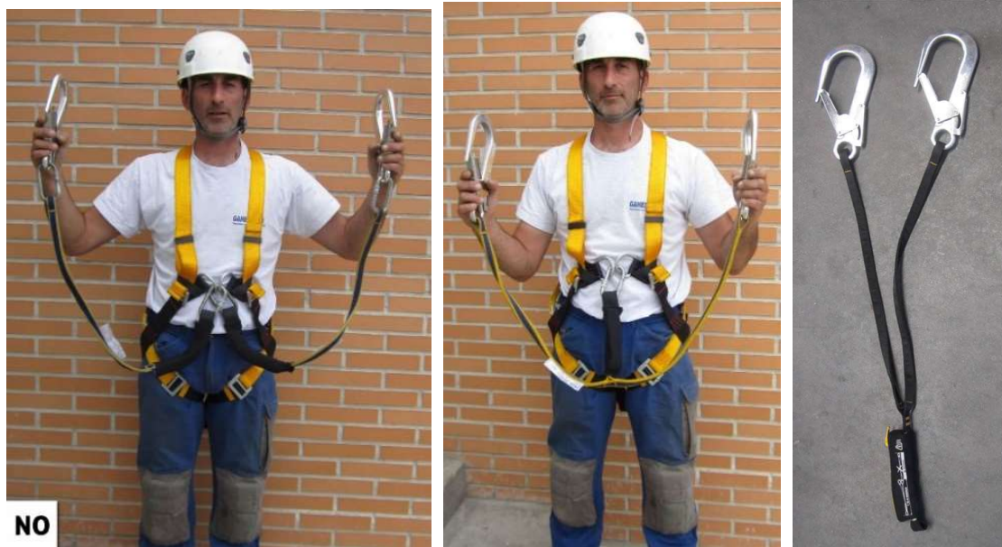
Fig. 5.4.3-1. Dos absorbedores y doble amarre con un sólo absorbedor.
