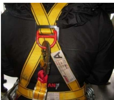
Fig. 4.1.1-5. Anclaje dorsal marcado con una “A”.
