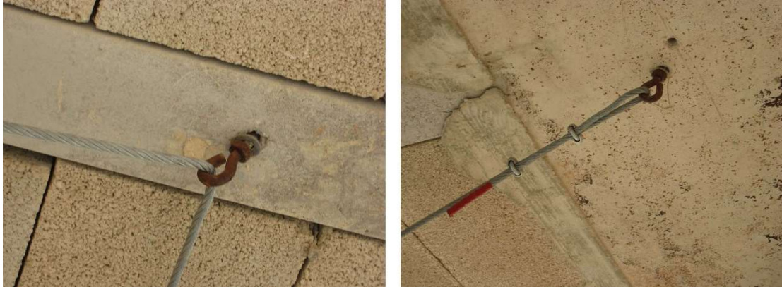
Fig. 8.5.2-2. Estado de los anclajes tras ejercer una fuerza de 200 daN sobre el cable en dirección vertical. El anclaje que obliga a un cambio de dirección del cable recibe más fuerza y se deforma más.
