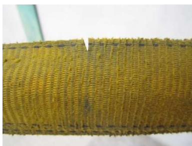
Fig. 9.3.2-2. Corte en el borde de una cinta.
