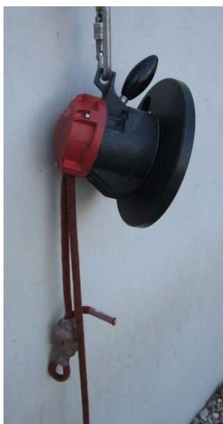
Fig. 10.2.2-1. Descensor con sistema incorporado (volante) para una pequeña elevación.
