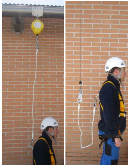
Fig. 5.2.1-4. Cualquiera de las disposiciones está mal. La de la derecha puede ser muy peligrosa.
