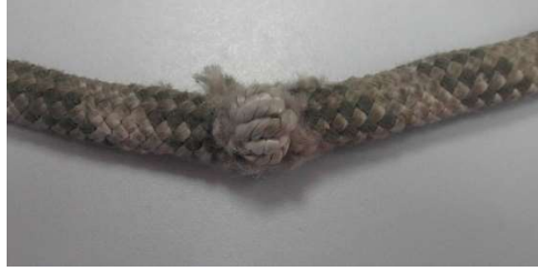
Fig. 5.7.6-3. Cuerda en mal estado.
