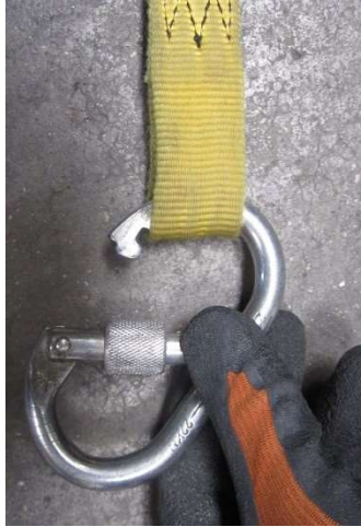
Fig. 5.3.3-5. Conector con diente.
