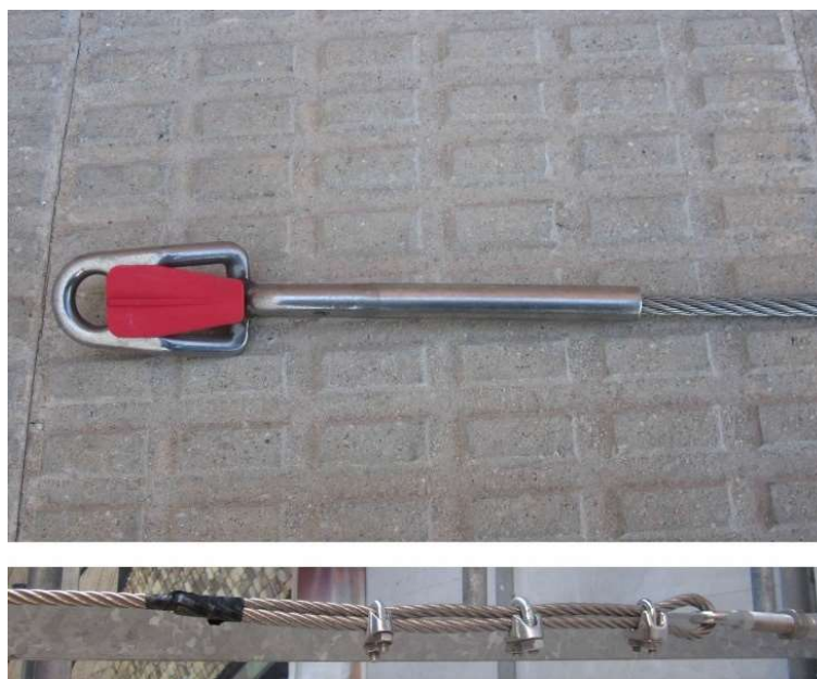
Fig. 7.5.2-7. Diferencia entre una pieza engarzada que se puede certificar y con abrazaderas o perrillos que no se puede certificar EN 795:2012.
