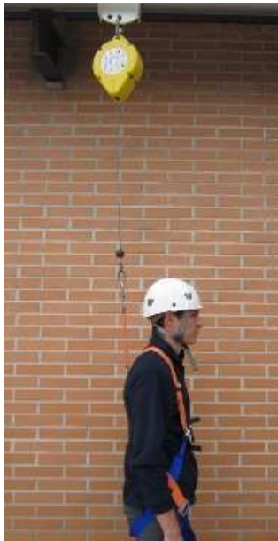
Fig. 4.1.8-2. Cinta extensora bien utilizada con retráctil.
