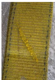
Fig. 9.3.2-3. Corte superficial. En este caso son muy pocas fibras las cortadas.
