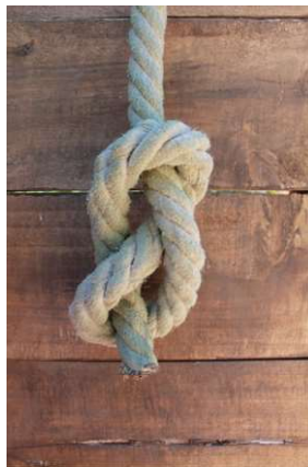
Fig. 5.7.4-1. Nudo de 8, nudo de terminación.
