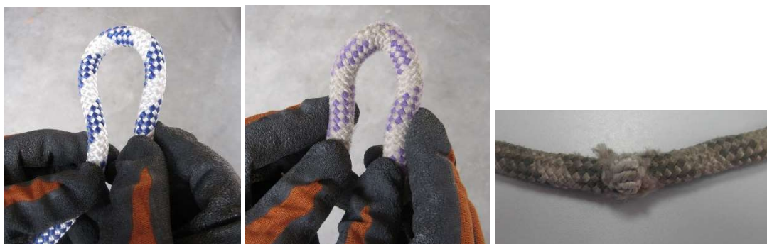
Fig. 9.3.2-5. Forma de la cuerda en buen estado y dos casos que exigen la retirada de la cuerda.
