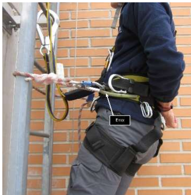
Fig. 4.1.8-6. Error al equivocar la anilla de sujeción con el portamaterial. Si se rompe, actuará el sistema anticaída.
