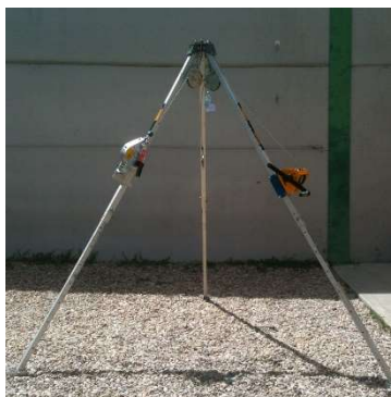
Fig. 10.2.5-1. Trípode con retráctil con sistema de salvamento mediante izado incorporado y torno. El torno no se debe utilizar para elevar o bajar a una persona hasta su lugar de trabajo.
