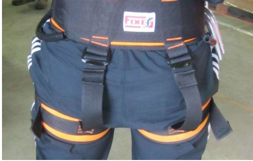
Fig. 4.1.4-9. Regulación de cinta que une perneras a cinturón.
