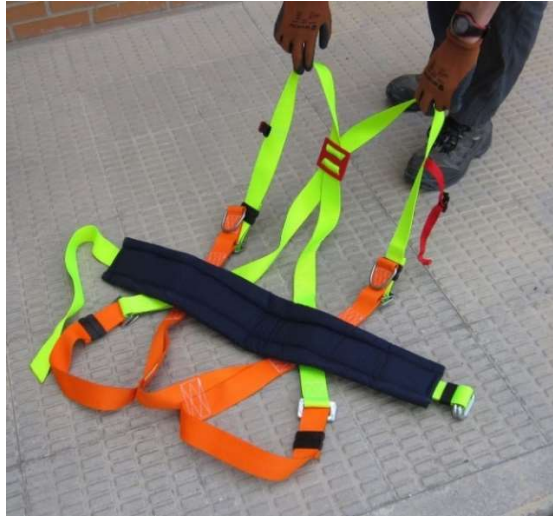
Fig. 4.1.4-11. Arnés anticaída con cinturón de sujeción.
