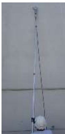
Fig. 7.4.5-1. Ejemplo de uso de pértiga para conectar una plaqueta inaccesible.
