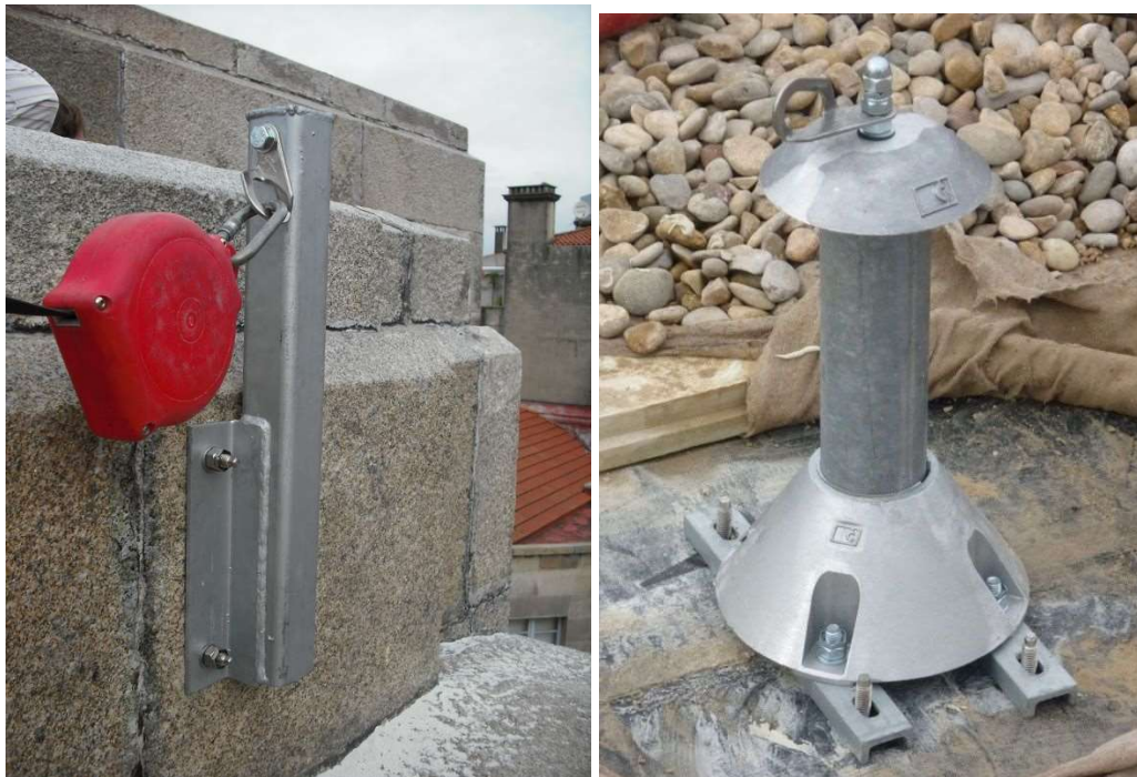
Fig. 7.3.4-16. Soporte con plaqueta de anclaje fijado en paramento de roca y hormigón.
