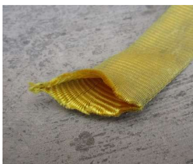
Fig. 9.3.2-1. Estructura de una cinta tubular.
