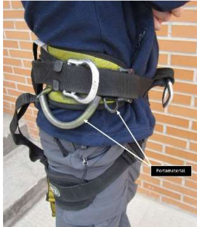
Fig. 4.1.8-5. Portamaterial del arnés.
