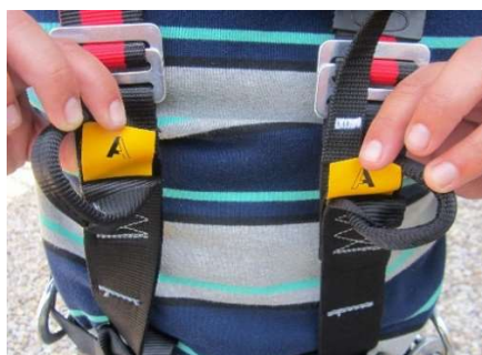
Fig. 4.1.1-9. Marcado que indica la necesidad de unir los dos bucles para generar un punto de enganche anticaídas.
