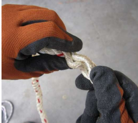
Fig. 5.1.8-2. Forma de revisar cuerdas torcidas.
