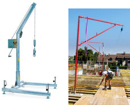
Fig. 7.4.6-2. Horca móvil con estabilizadores (en este caso, equipada con dispositivo de rescate) o sistema giratorio 360° con punto de anclaje por encima de la cabeza del usuario, en fase de encofrado horizontal.
