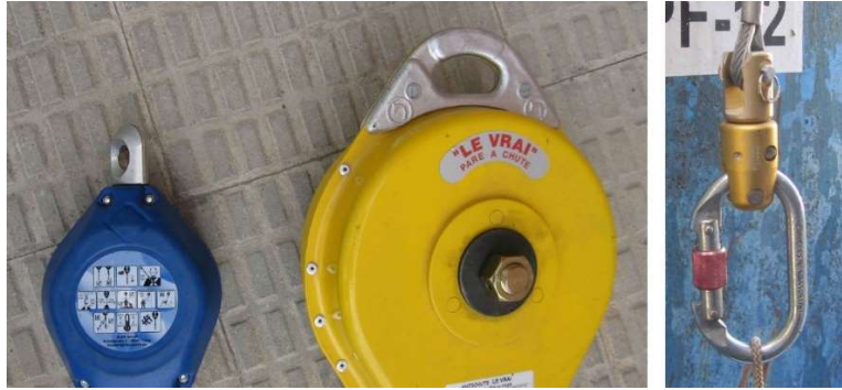
Fig. 5.5.1-2. Sistemas giratorio y fijo en el dispositivo o en el equipo de amarre.
