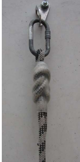
Fig. 5.7.4-2. Nudo de terminación de anclaje con conector unido a una plaqueta.
