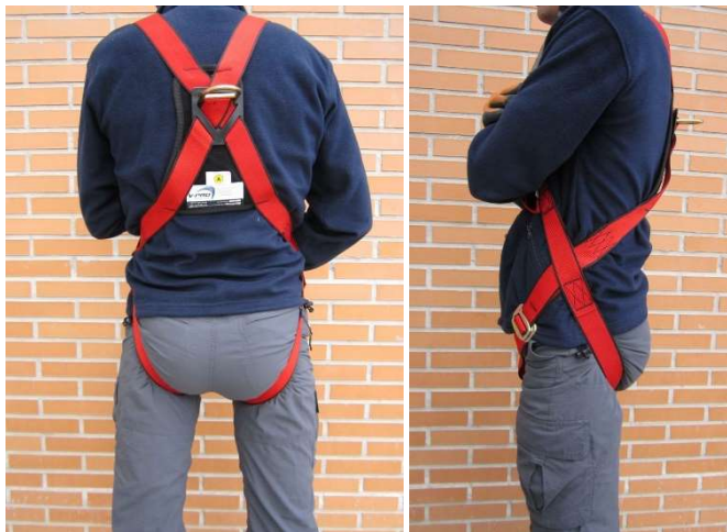
Fig. 4.1.4-19. Arnés sin banda subglútea. Las cintas deben rodear la pelvis.
