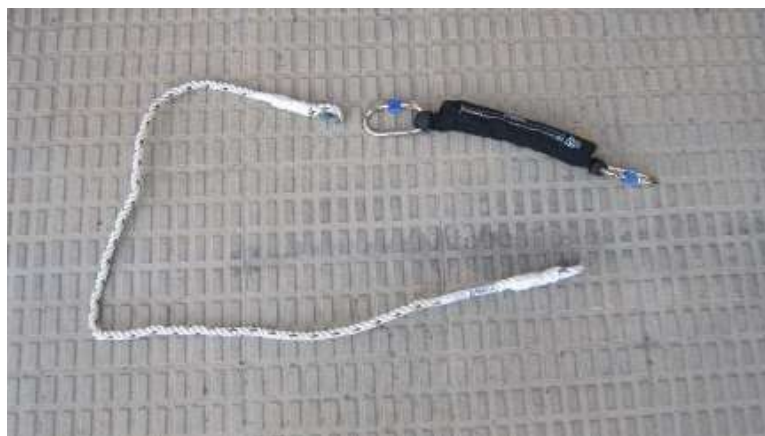
Fig. 5.2.1-1. Un equipo de amarre unido a un absorbedor compatible con él se convierte en un sistema de conexión anticaídas. (su longitud debe ser inferior a 2m).
