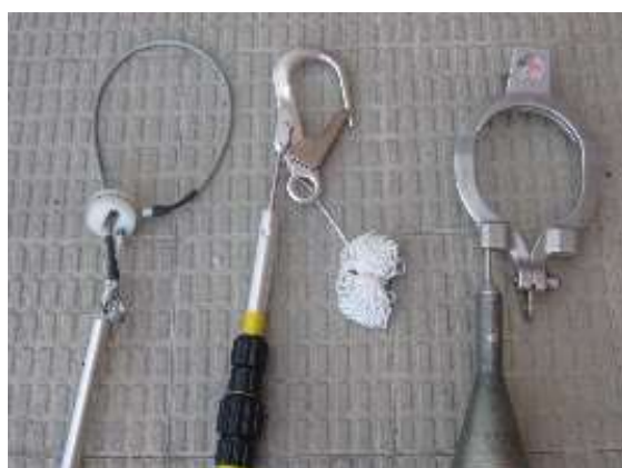
Fig. 7.4.5-2. Diferentes terminaciones de pértiga en función del anclaje disponible.
