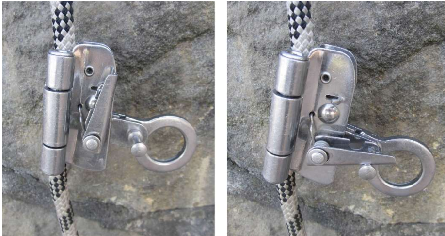
Fig. 6.3.1-4. Dispositivo deslizante sin bloquear y bloqueado.
