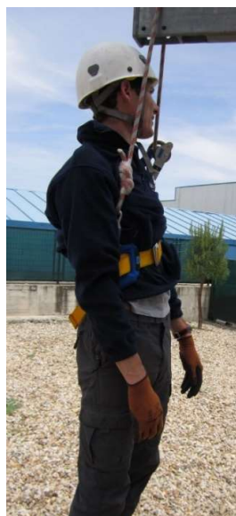
Fig. 4.2.1-2. El cinturón conectado por las dos anillas se sube en caso de caída.
