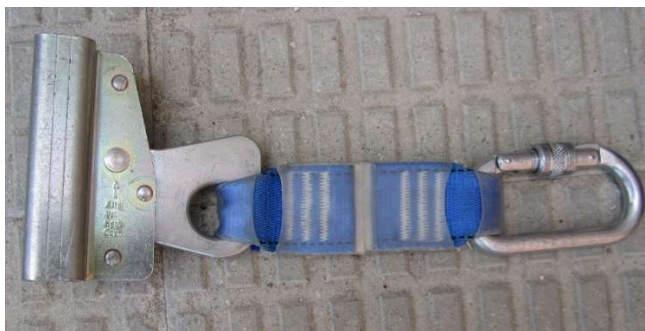
Fig. 5.4.1-4. Dispositivo deslizante sobre línea de anclaje rígida (ver apartado 6.2) con absorbedor incorporado (imposible de separar sin dañar el conjunto)
