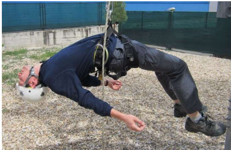
Fig. 4.1.1-1. Posición del cuerpo inconsciente utilizando el anclaje ventral.
