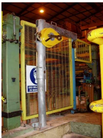
Fig. 7.3.4-25. Utilización de soportes tipo horca en un espacio confinado y en trabajo de encofrado.
