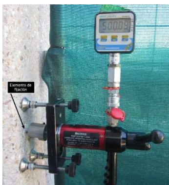
Fig. 7.3.3-2. Dispositivo de tracción para probar anclajes.
