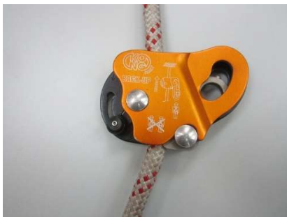
Fig. 6.4.4-11. Sistemas anticaídas con bloqueo.
