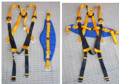
Fig. 4.2.1-7. Cinturón disociable separado del arnés y unido.
