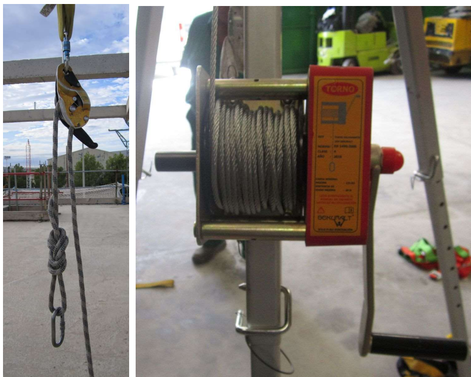
Fig. 10.2-1. Ejemplos de dispositivo de descenso (UNE-EN 341) y dispositivo de salvamento mediante izado (EN 1496).
