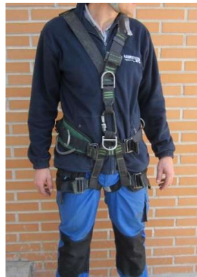
Fig. 4.1.4-2. Arnés anticaída con arnés de asiento incorporado.
