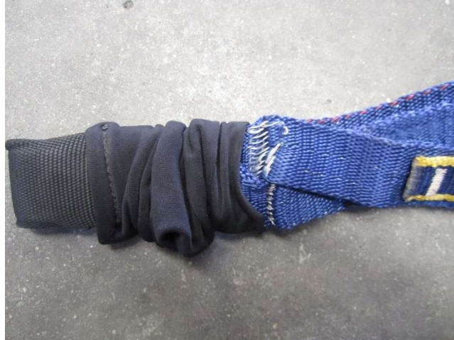
Fig. 5.4.2-4. Costuras de absorbedor rotas por abusar de su uso para sujeción.
