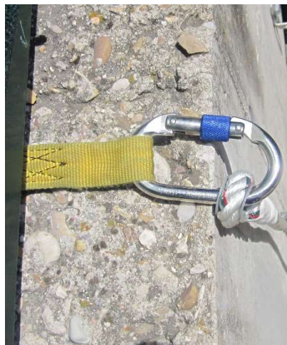
Fig. 5.3.5-1. Conector haciendo palanca.
