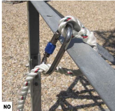
Fig. 5.3.5-2. Conector estrangulado.
