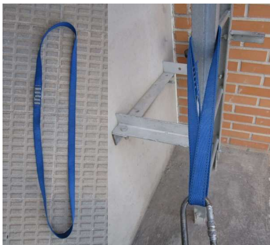
Fig. 7.4.2-1. Cinta de anclaje.
