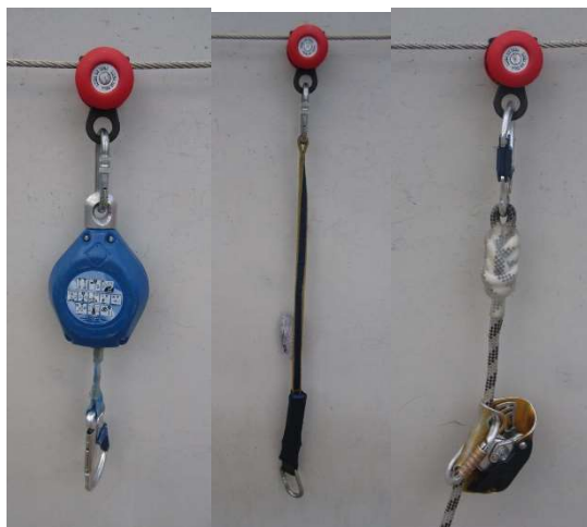
Fig. 7.5.3-1. Sistemas de conexión a una línea de anclaje flexible horizontal: Retráctil, absorbedor y línea de anclaje flexible.
