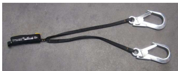
Fig. 5.6.2-3. Doble amarre con absorbedor.
