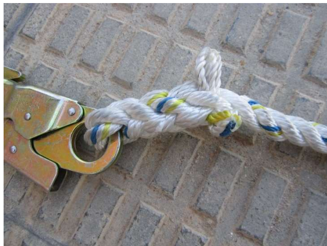
Fig. 5.7.4-5. Terminación ingerida.
