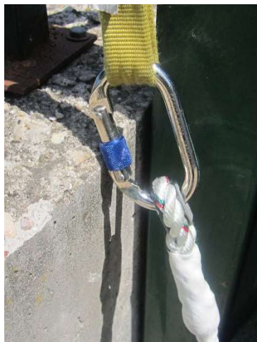
Fig. 5.3.4-7. Golpe del cierre contra borde de forjado.
