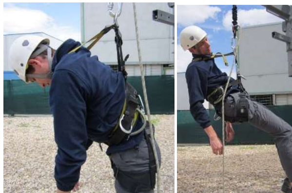
Fig. 4.1.4-4. Funcionamiento del anclaje dorsal y esternal con una persona inconsciente.
