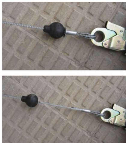
Fig. 5.5.9-2. Retirar la pieza de goma para comprobar el estado del cable.
