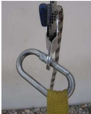
Fig. 5.3.5-5. Conector mal posicionado.
