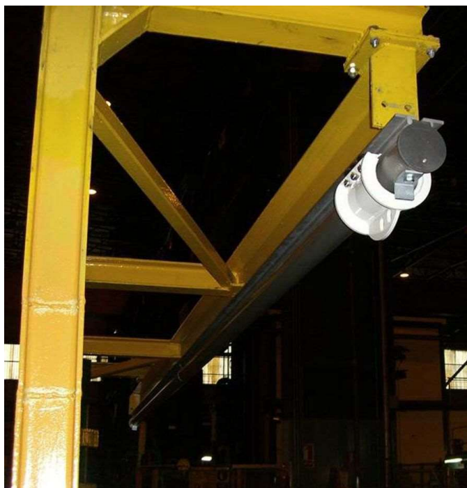
Fig. 7.6.1-2. Estructura que recibe un perfil y a éste se ha fijado el raíl.
