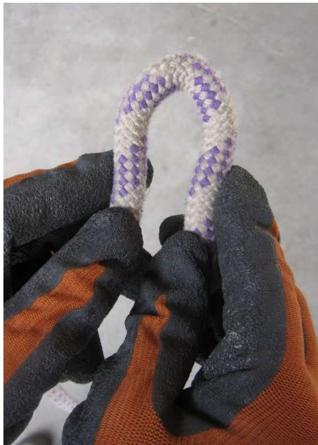
Fig. 5.7.6-2. Cuerda en mal estado.
