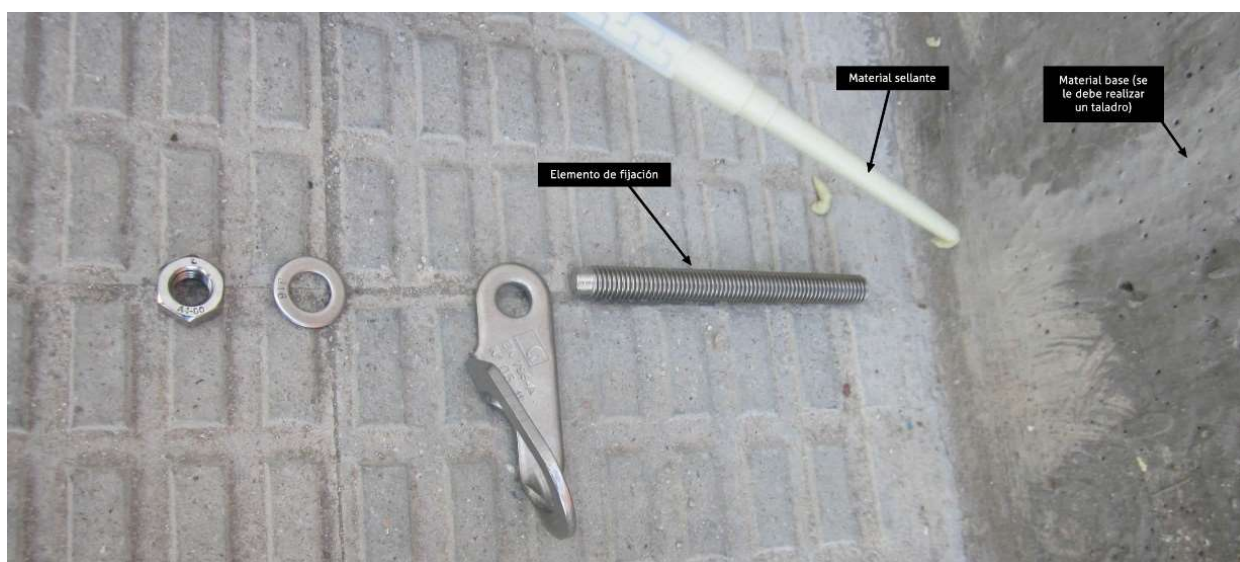
Fig. 7.3.3-1. Ejemplo de sistema de fijación de un dispositivo de anclaje.
