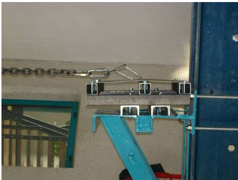
Fig. 7.3.4-15. Prueba de laboratorio de un soporte con un simple principio de deformación.
