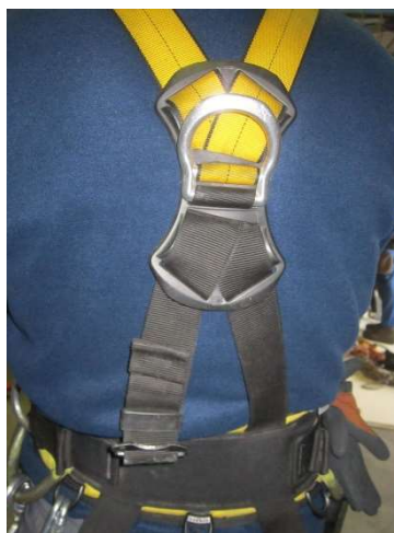
Fig. 4.1.4-8. Regulación de anclaje dorsal.
