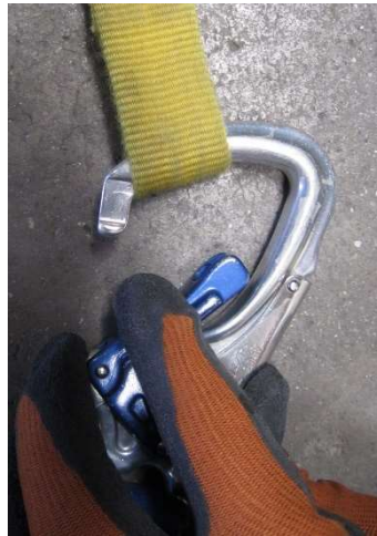
Fig. 5.3.3-6. Conector con Keylock.
