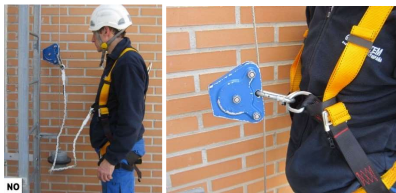
Fig. 5.2.1-3. Utilización peligrosa del equipo de amarre con un dispositivo deslizante. A la derecha, utilización correcta.
