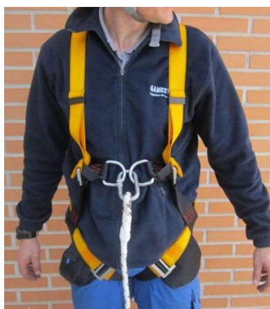
Fig. 4.1.1-6. Anclaje esternal (en este caso dos elementos unidos por un conector).
