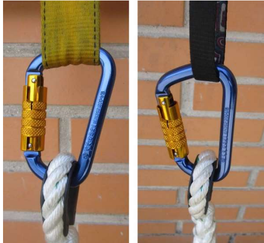
Fig. 5.3.4-4. La cinta más estrecha permite trabajar mejor al conector.
