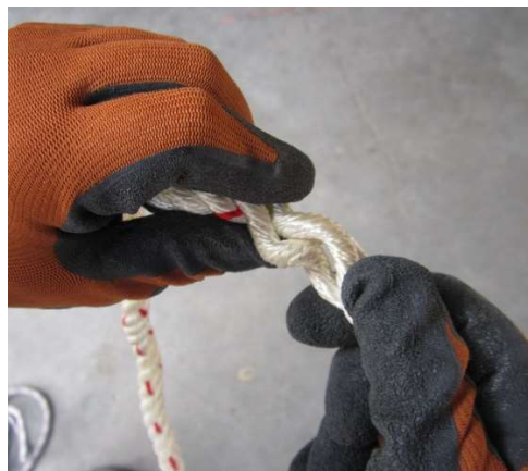
Fig. 5.7.6-4. Forma de revisar cuerdas torcidas.
