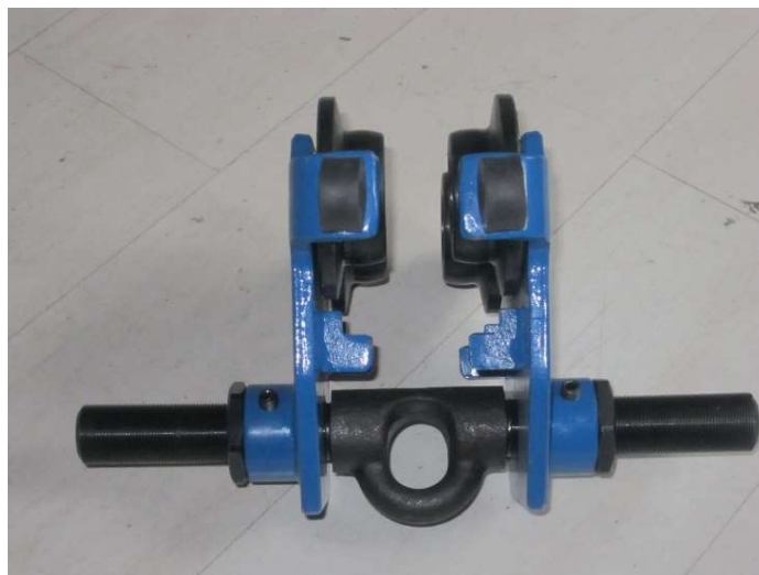
Fig. 7.4.3-2. Dispositivo con rodamientos para acoplar a perfiles.
