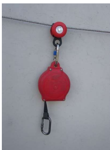
Fig. 7.5.1-3. Retráctil en línea de anclaje.
