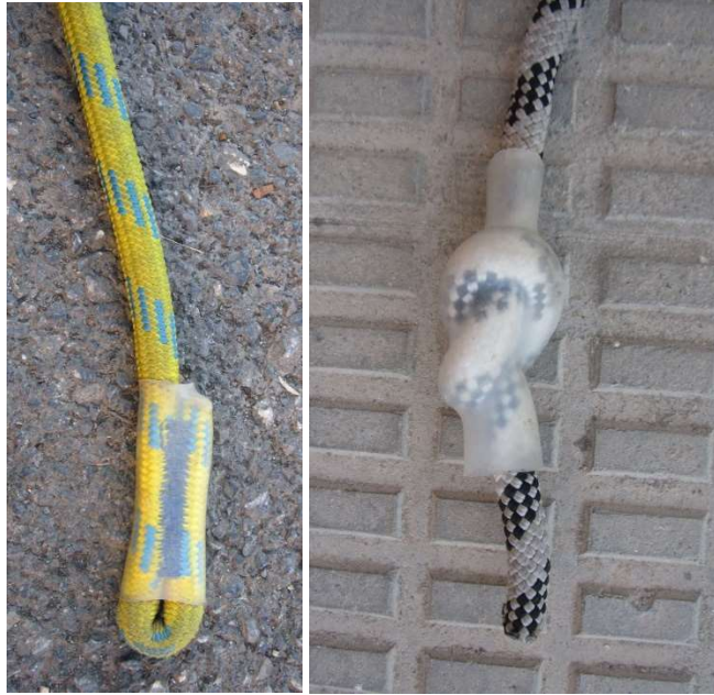
Fig. 5.7.4-7. Tope cosido y con nudo.
