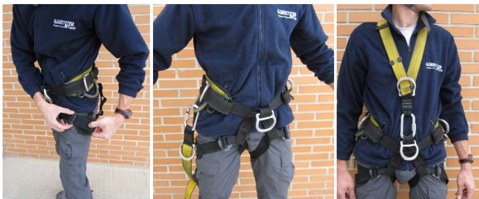
Fig. 4.1.4-6. Pasos 4,5 y 6. Obsérvese que el conector no se pone en la anilla.
