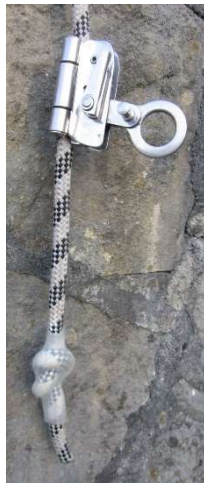
Fig. 5.7.4-3. Nudo de tope que impide la salida del dispositivo deslizante.
