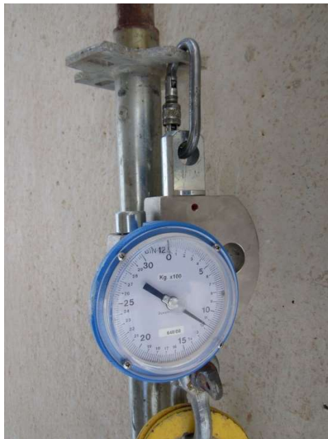
Fig. 8.7-2. Deformación casi indetectable pasados los 1100 daN.
