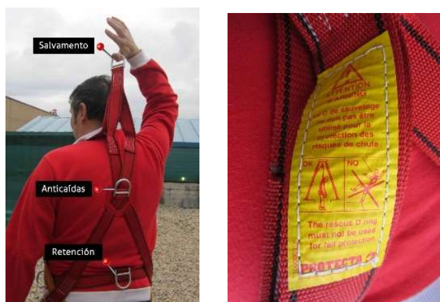
Fig. 4.1.1-11. Puntos de anclaje de salvamento, anticaídas y retención.
