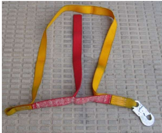
Fig. 5.4.1-5. Absorbedor rasgado parcialmente al detener una caída.
