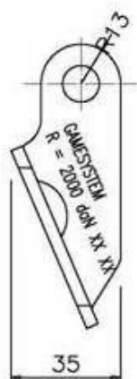
Fig. 7.3.4-1. Plaqueta alineada con la fuerza.
