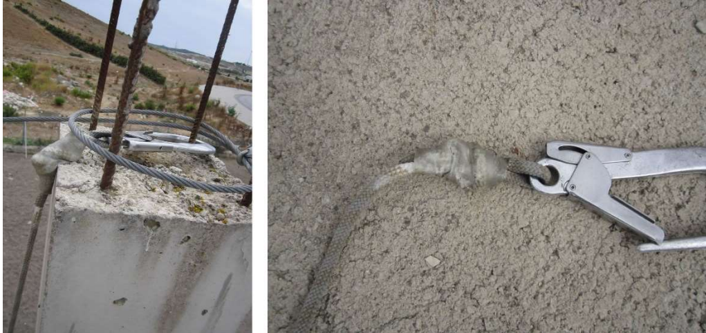
Fig. 8.4.3-5. Detalle de la forma de trabajo del equipo de amarre y estado final de la zona de rozamiento.
