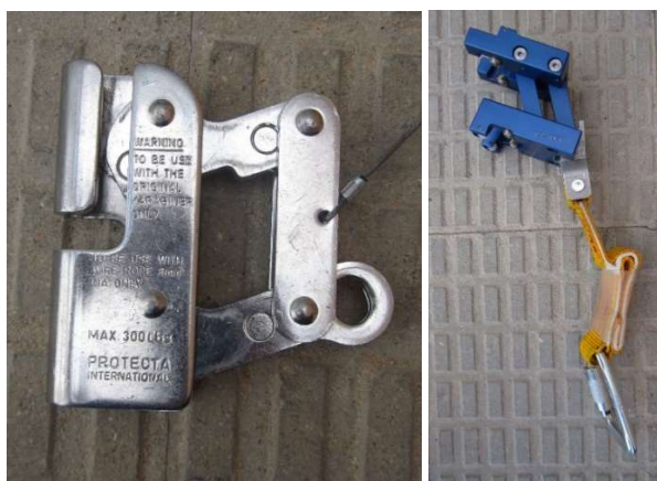
Fig. 6.2.1-5. Vista de las levas que “muerden” el raíl y el cable y sistema de frenado por “trapecio”.
