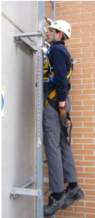
Fig. 4.2.1-3. A pesar de disponer de anticaídas, el accidentado se queda colgado del cinturón.
