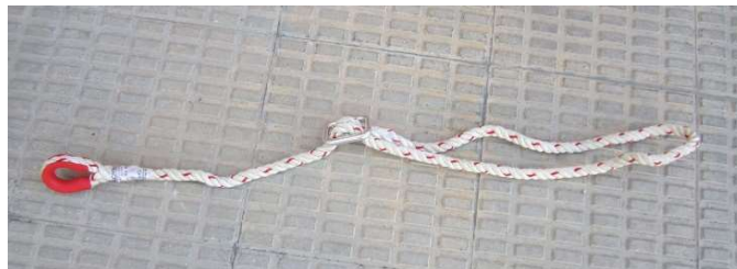
Fig. 5.1.4-2. Cuerda con regulación de hebilla.
