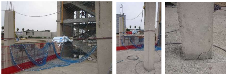
Fig. 8.4.2-1. Vistas de la prueba y estado final de uno de los pilares situado en el centro del forjado.
