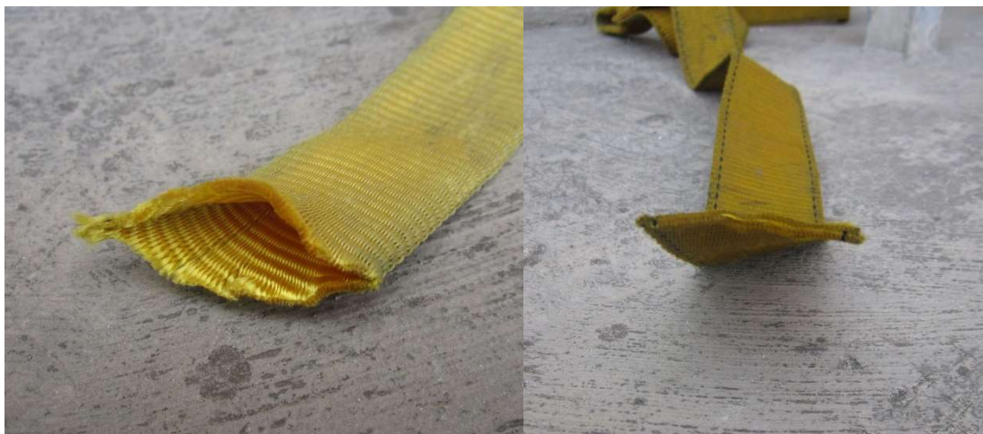
Fig. 7.4.2-3. Construcción de cinta de anclaje plana y tubular.
