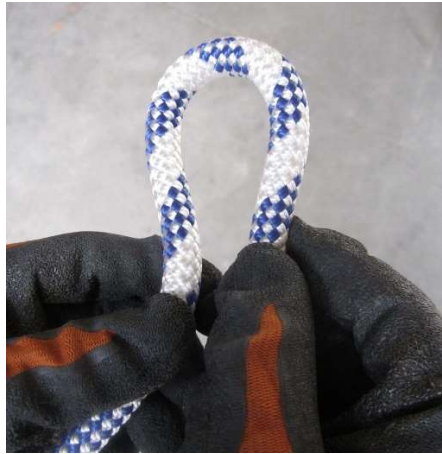
Fig. 5.7.6-1. Forma de revisar cuerdas trenzadas.
