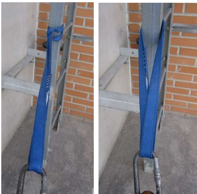
Fig. 7.4.2-5. Instalación de cinta con nudo de “alondra” y en terminación doble.
