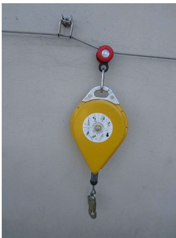
Fig. 7.5.3-2. Retráctil demasiado pesado para esta línea de anclaje.
