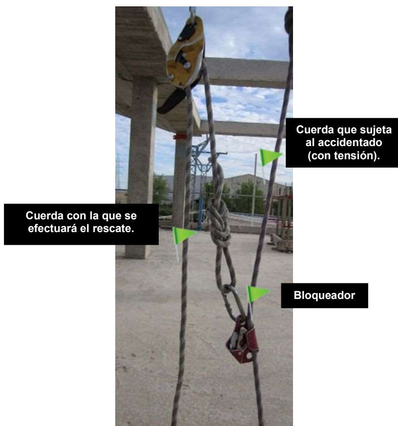
Fig. 10.2.1-3. Ejemplos de utilización de bloqueador sobre la cuerda del accidentado.
