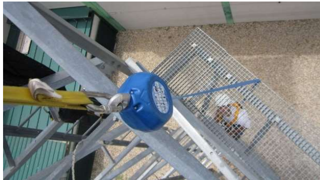
Fig. 5.5.1-4. Al estar anclado a la cinta amarilla, el dispositivo se alinea con el equipo de amarre (cinta azul).
