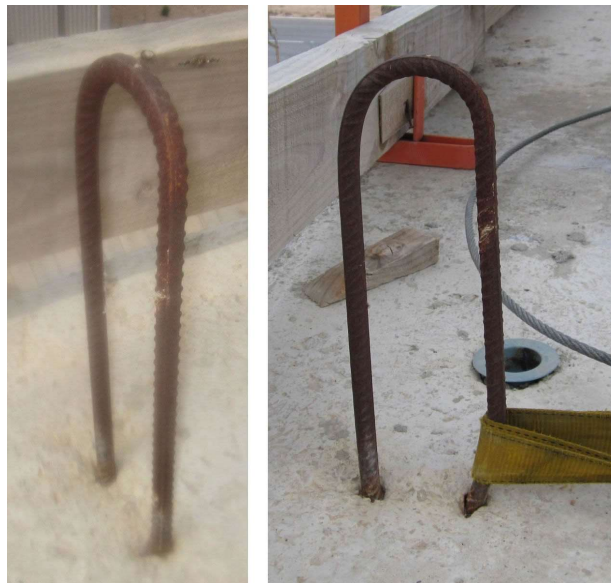
Fig. 8.1-1. Horquilla de varilla corrugada probada. La fuerza se hace en la dirección de la cinta amarilla.
