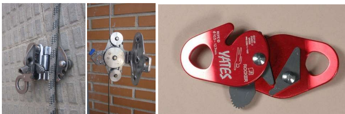
Fig. 6.3.1-2. Diferentes sistemas de frenado sobre línea de anclaje flexible.
