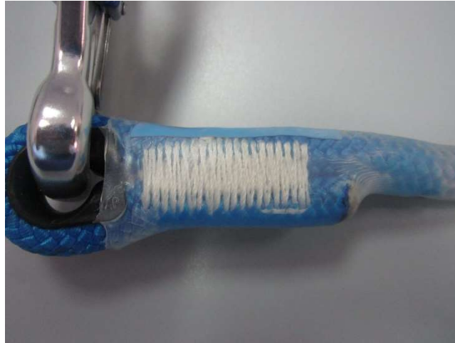
Fig. 5.7.4-4. Terminación cosida.
