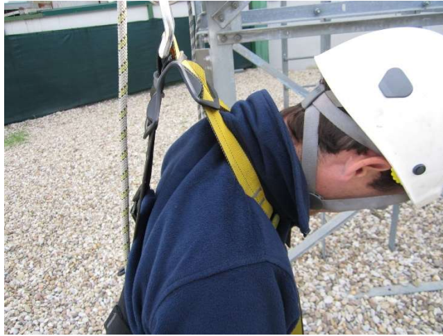
Fig. 4.1.4-7. Detalle da anclaje dorsal mal regulado.
