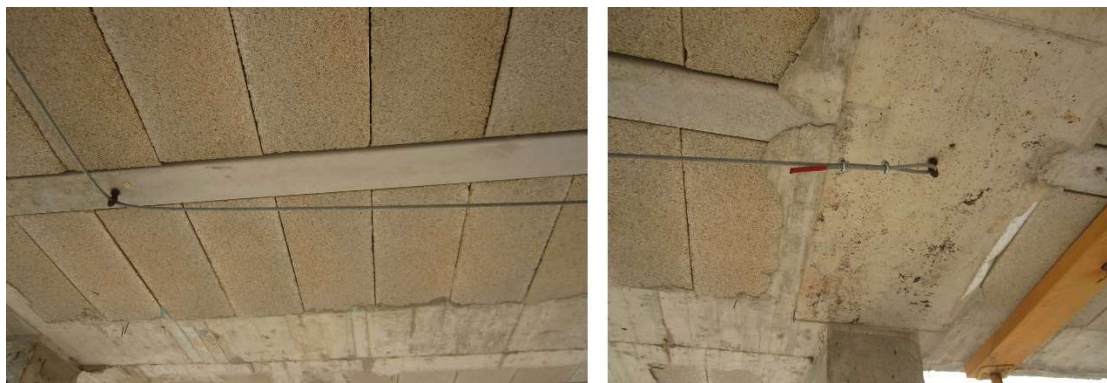
Fig. 8.5.2-1. Detalle de los dos anclajes entre los que se hace la prueba.
