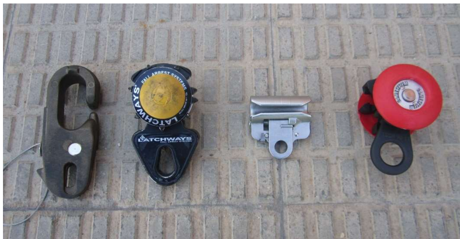
Fig. 7.5.2-5. Ejemplos de distintos puntos de anclaje móviles que superan las piezas intermedias.
