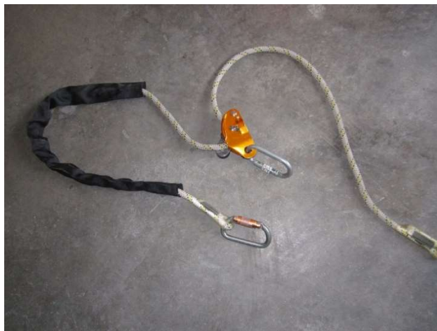
Fig. 5.1.4-5. Elemento de regulación por excéntrica.
