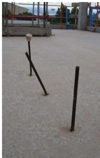
Fig. 8.2-1. Deformación de la varilla en la prueba con 1000 daN.
