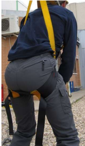
Fig. 4.1.4-16. Actuación de banda subglútea utilizando anclaje dorsal.
