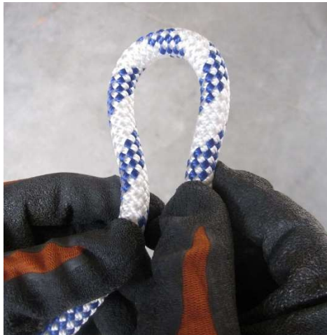
Fig. 5.1.8-1. Forma de revisar cuerdas trenzadas.
