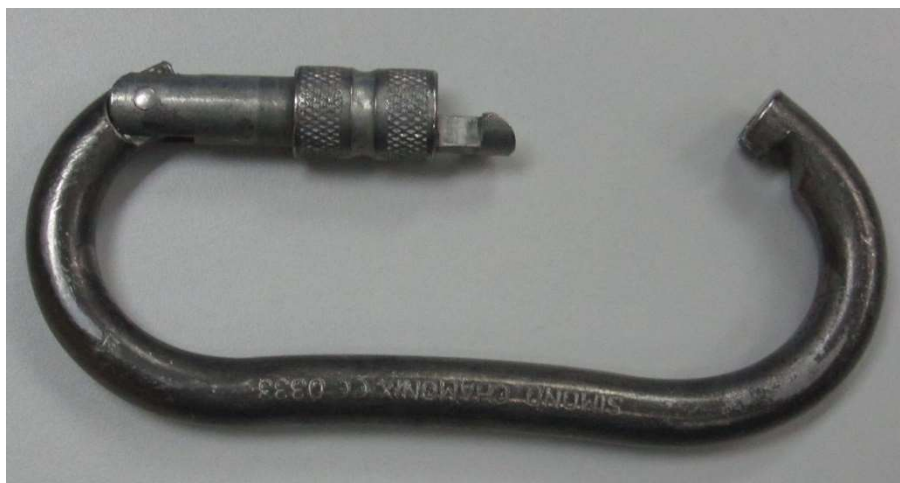
Fig. 5.3.4-1. Deformación de conector por trabajar con el cierre abierto.
