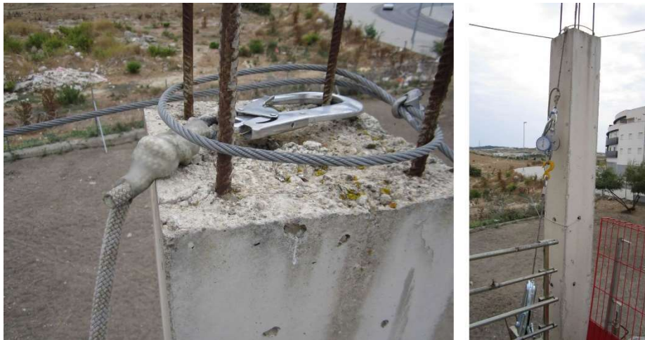
Fig. 8.4.3-4. Situación del conector y vista de la prueba (El cable de las esperas no forma parte de la prueba).
