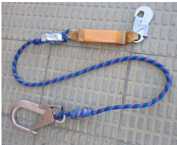
Fig. 5.4.1-2. Absorbedor con equipo de amarre incorporado. (UNE-EN-355)
