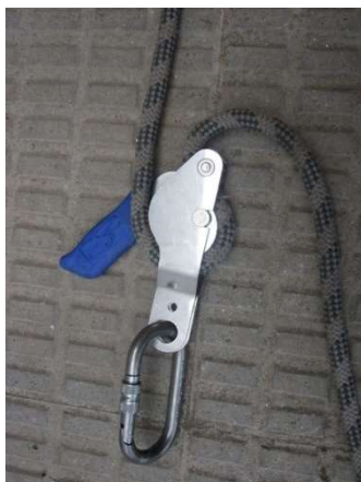
Fig. 6.4.4-12. Sistema anticaídas que facilitan el descenso.
