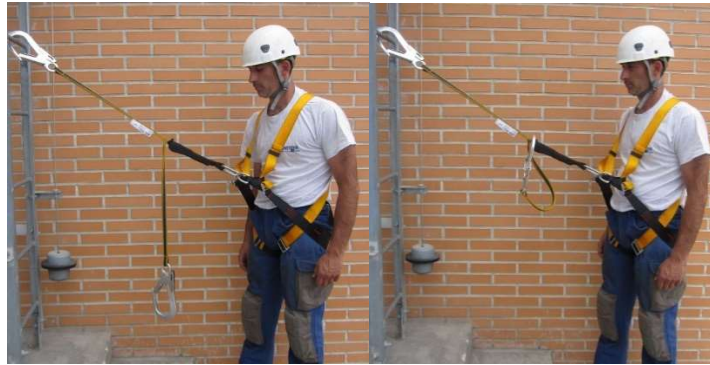
Fig. 5.6.2-4. Gancho suelto y gancho sujeto.
