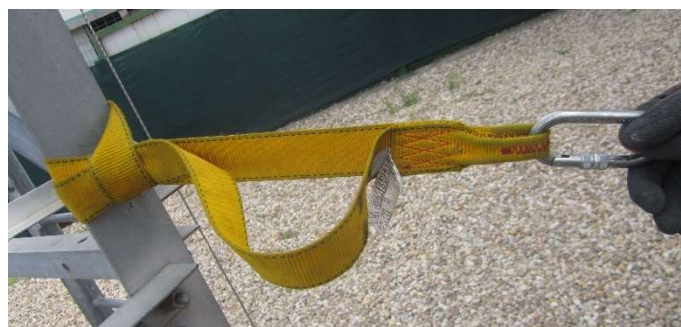
Fig. 9.3.3-4. Una parte de la cinta ejerce más fuerza que la otra.
