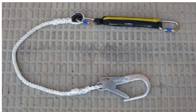
Fig. 5.4.1-3. Absorbedor y equipo de amarre independientes unidos por un conector. (UNE-EN 354 y 355)
