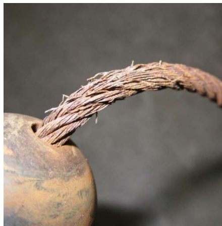
Fig. 5.5.9-1. Cable de retráctil muy peligroso.
