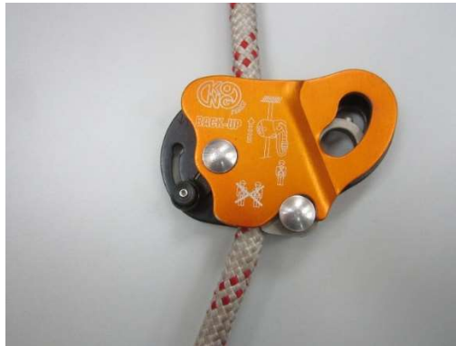
Fig. 6.4.3-2. Sistema deslizante con bloqueo.
