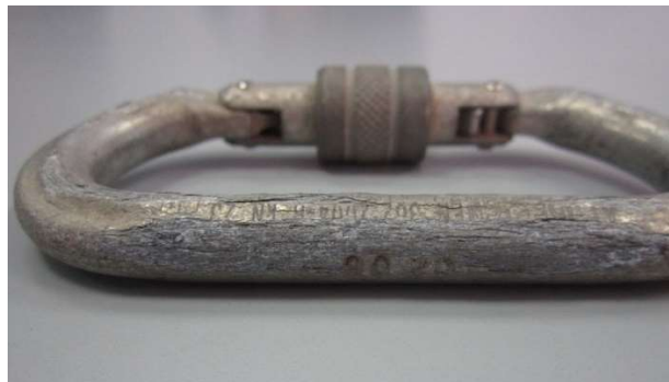
Fig. 5.3.2-2. Conector de aluminio con signos evidentes de corrosión.
