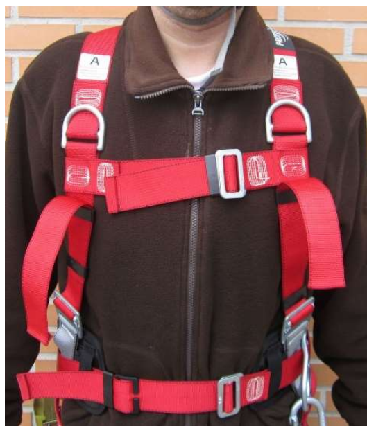
Fig. 6.2.1-2. Elementos de anclaje laterales del arnés.
