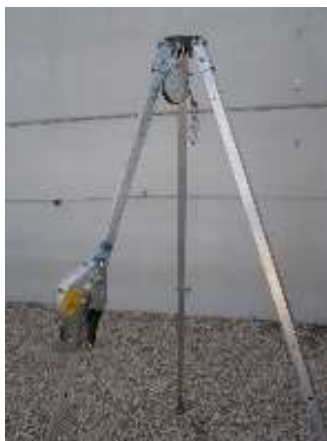
Fig. 7.4.6-7. Trípode con poleas situadas debajo de la pieza de unión de las tres patas.
