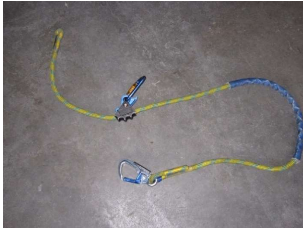
Fig. 5.1.4-4. Elemento de regulación de leva.
