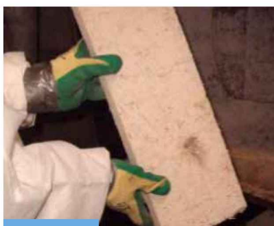
Ladrillo de amianto. Material muy friable.
