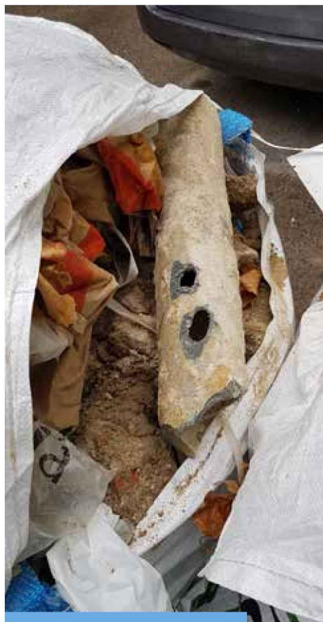
Muchas empresas desconocen que los residuos de amianto deben ser gestionados como residuos peligrosos.
