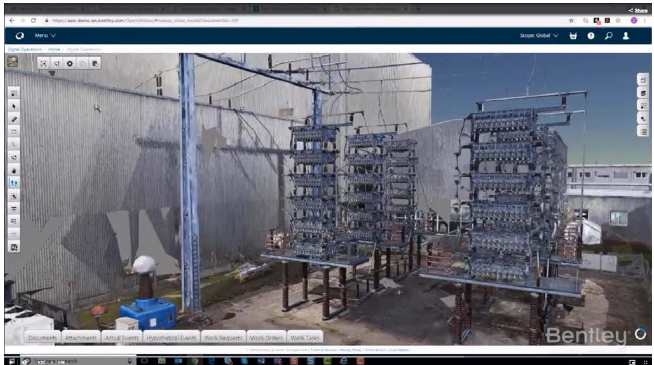
Figura 1. Digital Twin Predictivo, modelado para una subestación por Bentley Systems.
