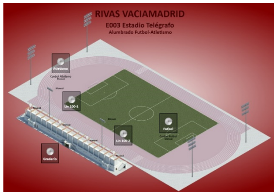
Figura 4. Control horario de alumbrado de instalaciones deportivas.
