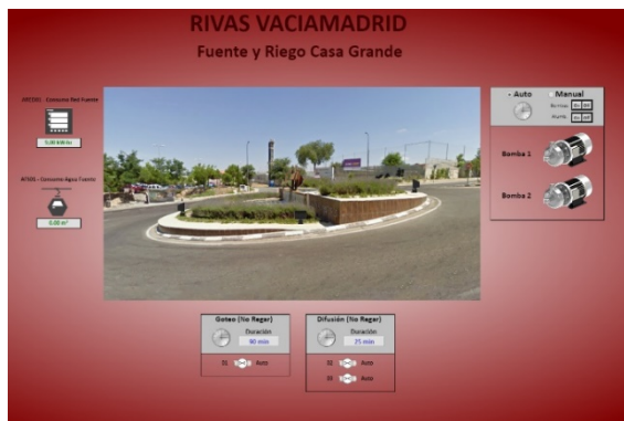
Figura 5. Control horario fuentes y riego.
