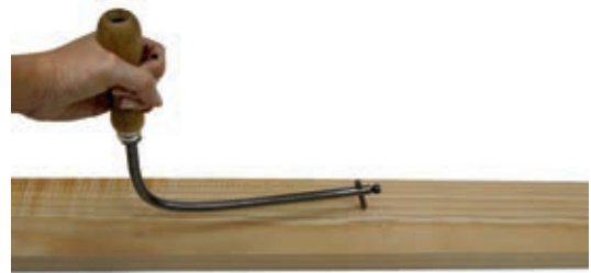
Medición de la desviación de la fibra con trazador
