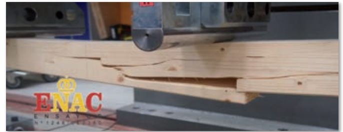
Rotura Ensayo de Flexión
