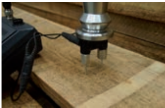
Medición de la humedad con Xilohigrómetro Gann Hydromette RTU 600
