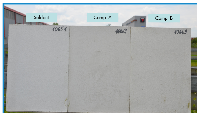
Figura 82: Comparativa de autolimpieza de pintura fotocatalítica con convencionales tras 5 años de exposición a intemperie. Fuente: KEIM.
