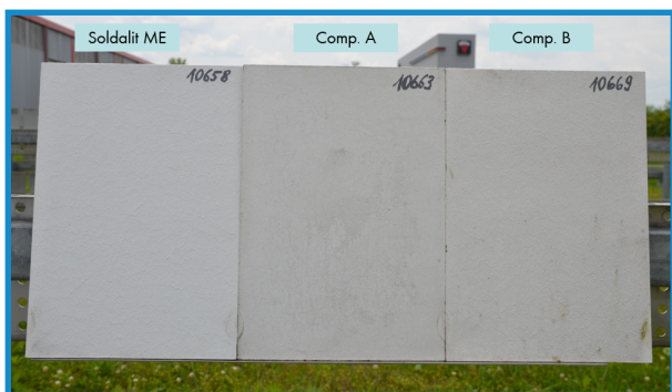
Figura 83: Comparativa de autolimpieza de pintura fotocatalítica con convencionales tras 5 años de exposición a intemperie. Fuente: KEIM.
