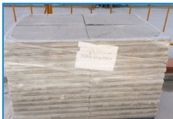
Figura 46: Suministro de baldosas prefabricadas con hormigón fotocatalítico. Fuente: Light2cat.
