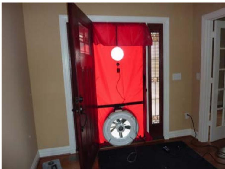
Por todo ello, se requiere realizar un test de presurización que permita detectar posibles infiltraciones, denominado BlowerDoor. Consiste básicamente en mantener una depresión controlada en la sala (50 Pa) y comprobar que el caudal mantenido es inferior a las 0,6 renovaciones/hora requeridas.
