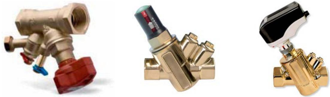
Figura 3.2. Izquierda: válvula de equilibrado estática. Centro: válvula de equilibrado dinámica con ajuste manual del caudal. Derecha: válvula de equilibrado dinámica con ajuste exterior del caudal.
