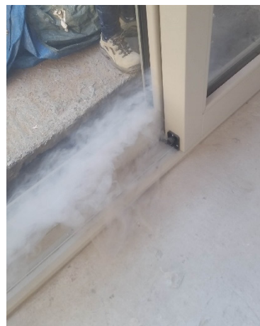
Figura 10. Imagen tomada durante el test Blower Door en el Edificio F, donde el paso de aire es mucho mayor.
