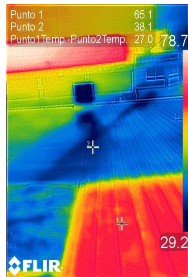
Figuras 1 y 2. Cubierta metálica tratada con pintura termo-reflectante Thermodry. Imagen captada a las 16h. Diferencia de temperatura superficial entre zona con pintura Thermodry y zona sin tratar de 27 grados.
