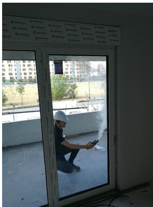
Figura 2. Detección de infiltraciones mediante generador de niebla vaporizada.
