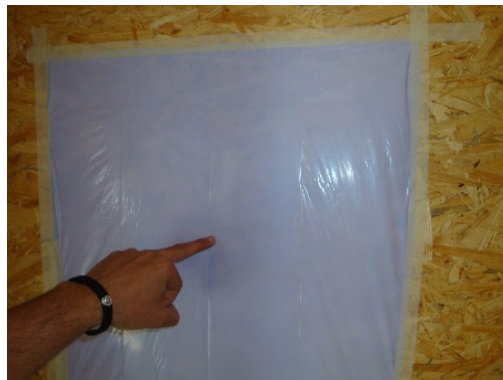
Figura 8. Durante el test Blower Door en el Edificio A, se observó que el plástico se hinchaba de aire exterior que se infiltraba a través del panel.
