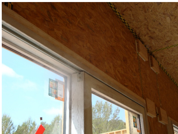
Figura 9. Imagen tomada durante el test Blower Door en la vivienda D, donde se observa un leve paso de aire durante la depresión producida.
