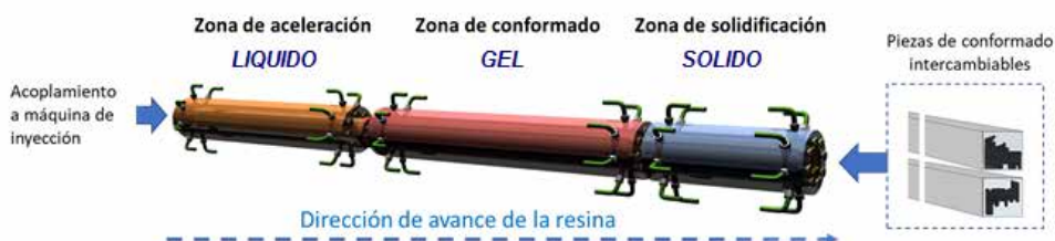
Figura 3. Configuración del dispositivo de extrusión EXTRU -PUR.
