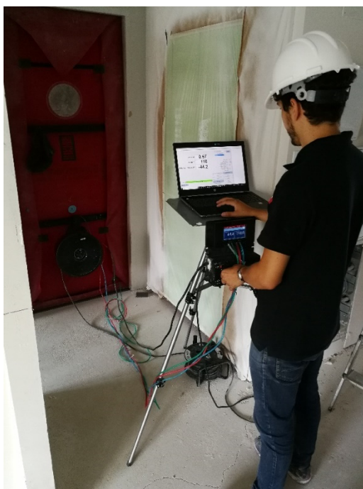
Figura 1. Realización del test Blower Door.
