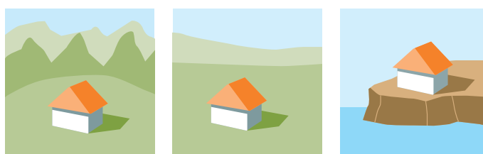
Figura 33. Esquema de los distintos tipos de situaciones de la vivienda: protegida, normal y expuesta
