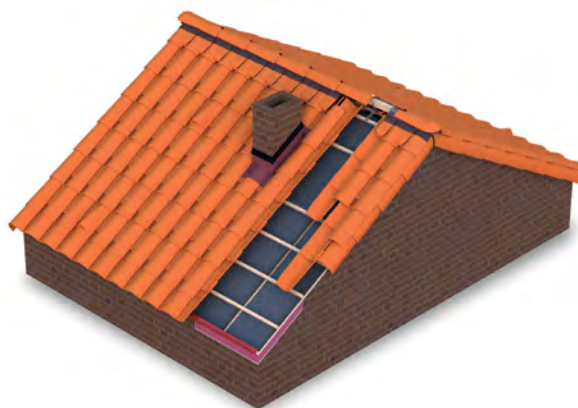
Figura 38. Esquema de cubierta ventilada de teja
