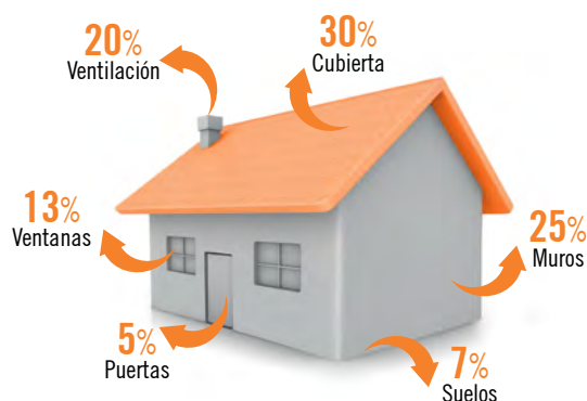
Figura 35. Puntos donde se producen las principales pérdidas energéticas del edificio
