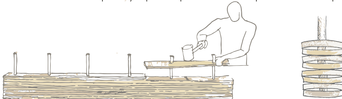
Figura 56. Proceso de apilado de latas.
