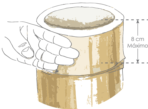
Figura 18. Separación máxima del nudo.
