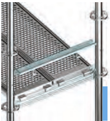
Cierre de seguridad. Se trata de una pieza que se encaja en el perfil en "U" de los elementos de apoyo (horizontales, vigas puente y vigas celosía) una vez colocadas las plataformas.
