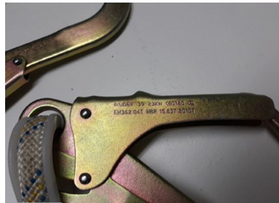
Detalle del marcado del gancho.
