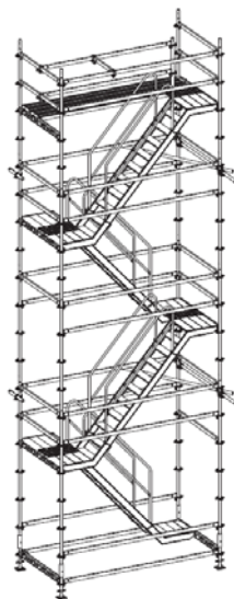
Escalera zanca de tramos alternados.
