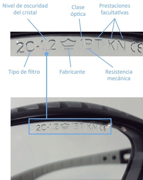
Marcado ocular de gafas de protección.
