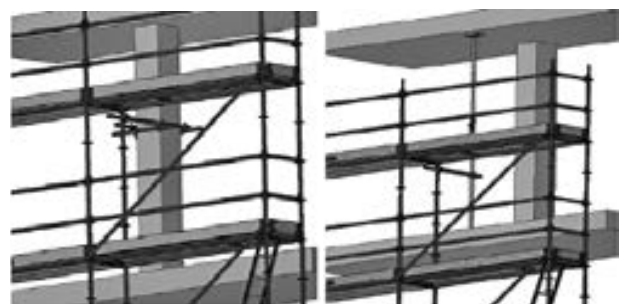
Foto izquierda Amarre a columna, tipo “collarín” Foto derecha Amarre a puntal
