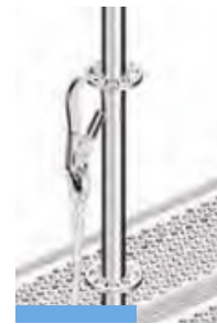
Roseta entre nudos arriostrados a menos de 1 m.
