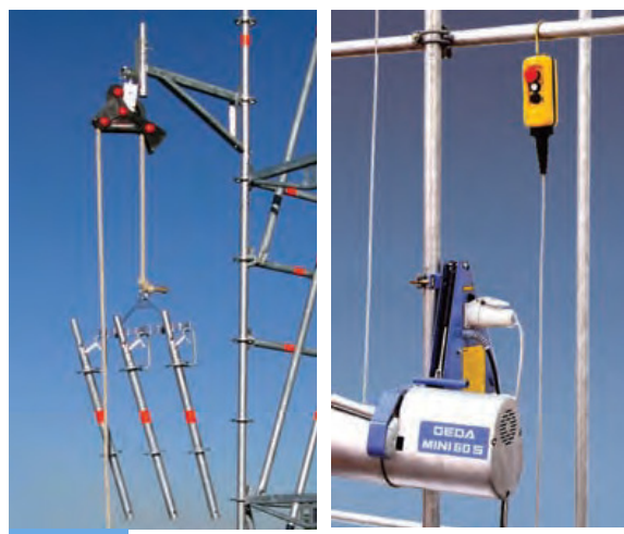
Polea y maquinillo. Para el izado de materiales y cargas, únicamente se acoplarán al andamio equipos de elevación de cargas, cuando así esté considerado en el diseño del mismo.
