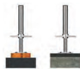
Cuando se tengan dudas sobre la resistencia de las zonas de apoyo del andamio o cuando el terreno no ofrezca la capacidad necesaria para la presión que se va a ejercer, se pondrá un tablón de reparto o durmiente.
