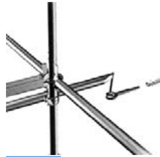
Componentes del amarre por tacos expansibles
