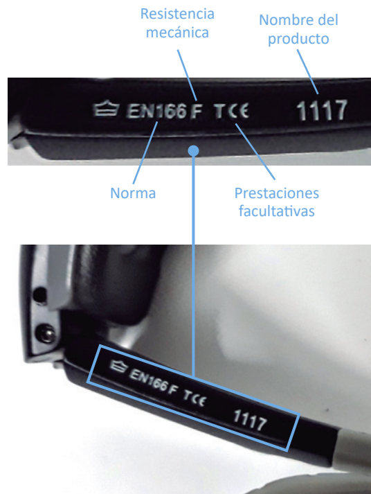
Marcado montura de gafas de protección.
