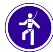
PROTECCIÓN OBLIGATORIA CONTRA CAÍDAS
