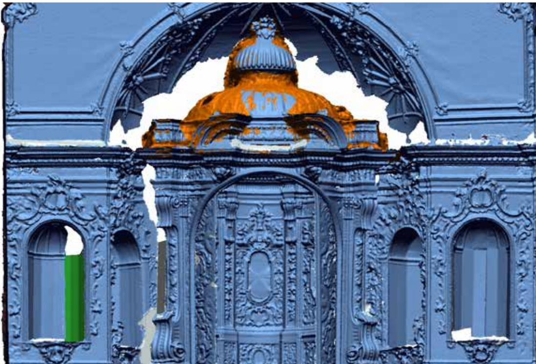
Fig. 4: Integración de datos del escáner láser (color azul), fotogramétricos (color naranja) y superficies de extrusión (color verde).
