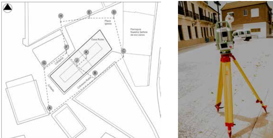
Figura 4. Posición de las estaciones de la poligonal cerrada y láser escáner Leica Nova MS50. Elaboración propia.
