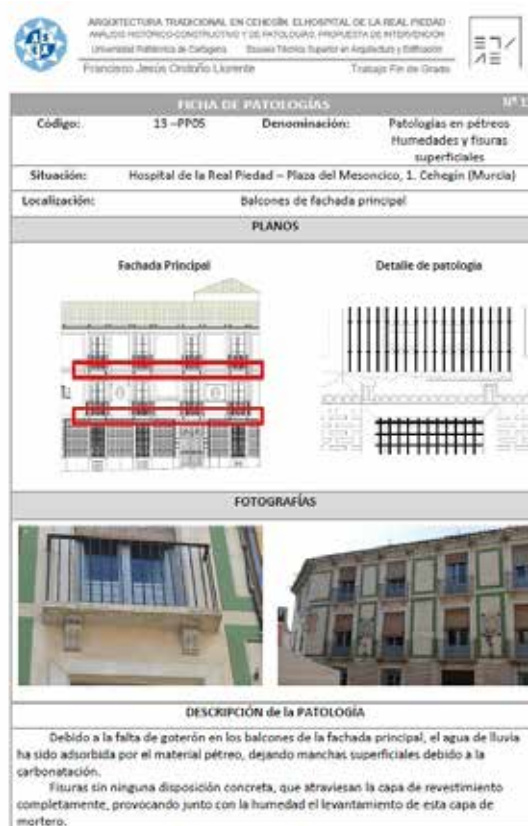
Fig. 6. Ejemplo de ficha de patología en fachada contenido en el TFG
