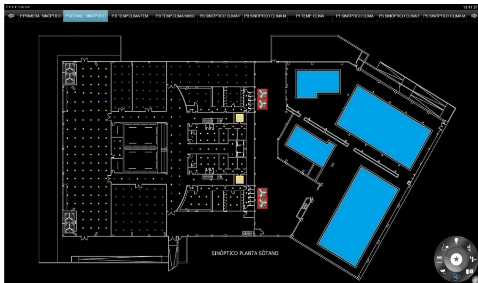
Figura 14. Esquemático de iluminación realizado por software scada GUI de Teletask.
