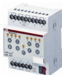
Figura 9. Entrada binaria 8 cables BE/S8.20.2.1, para el control de los pulsos de los contadores de energía y control del disparo de los diferenciales.
