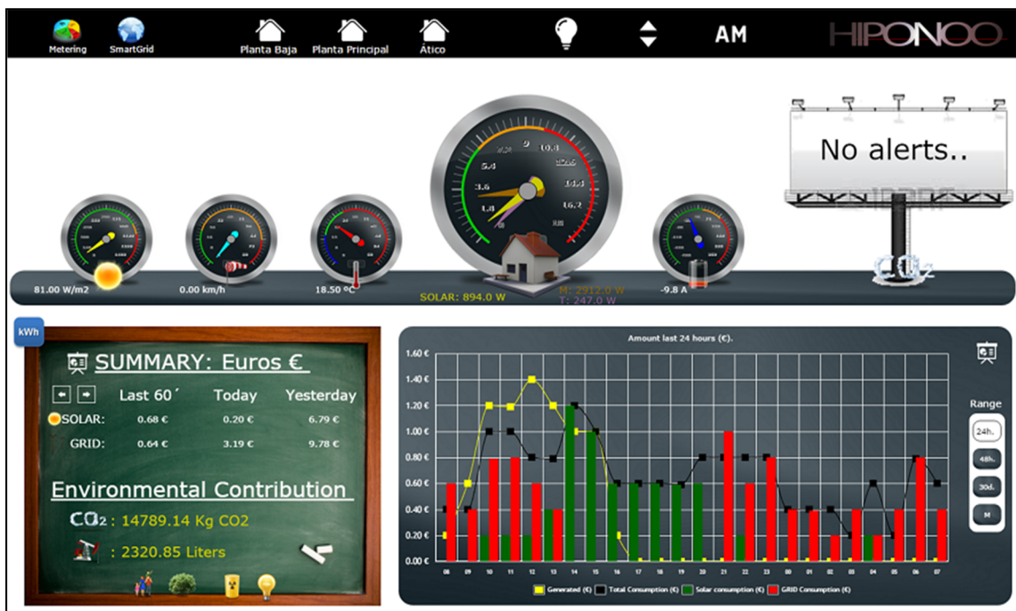
Figura 6. Visualización del sistema de SMARTMETERING.
