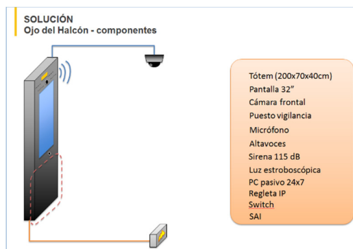
Figura 3. Componentes del tótem de Prosegur Ojo de Halcón.
