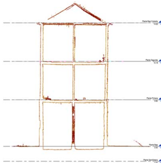
Fig. 5 Sección nube de puntos para medir la deformación de la estructura
