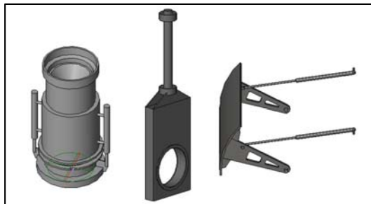
Fig. 4 Familias de válvula Howell y, compuertas Bureau y Taintor. Fuente: Elaboración propia
