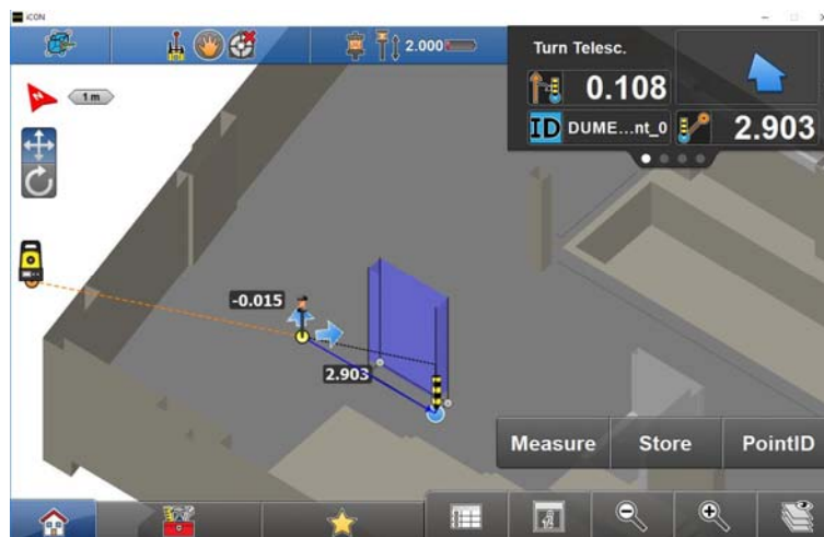
Fig. 6 Replanteo con Leica iCON del proyecto de París. Fuente: Propia (2018)
