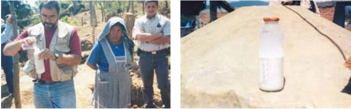
Figuras 39 y 40: A la izquierda, se añade agua al nivel de cal registrado y se mezcla. A la derecha, después del reposo, el nivel de la cal asentada aumenta si su poder cementante es bueno.
