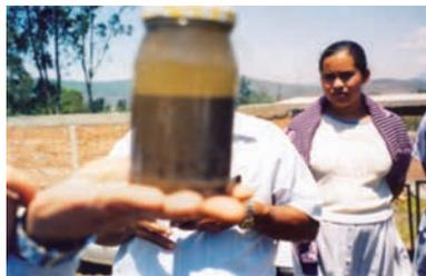
Figura 41. Prueba de la tierra para distinguir de manera general la proporción de arenas, limos y arcillas
