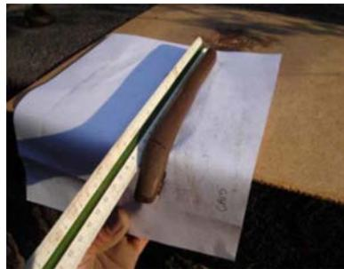
Figuras 44 y 45: La regla y barra se jalan juntas despacio hasta medir el punto de quiebre de la barra
