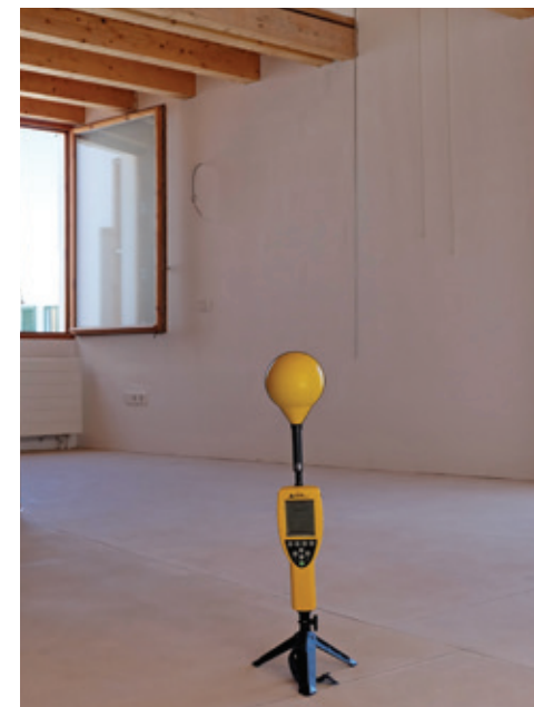
Medidor de campo magnético con sonda 3061 Broadband field meter with 3061 field probe
