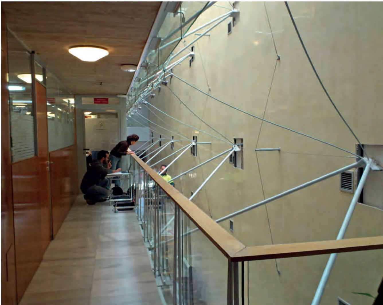
Figura 11. Destensado de tirantes decorativos durante el ensayo por vibración de los tirantes estructurales.
