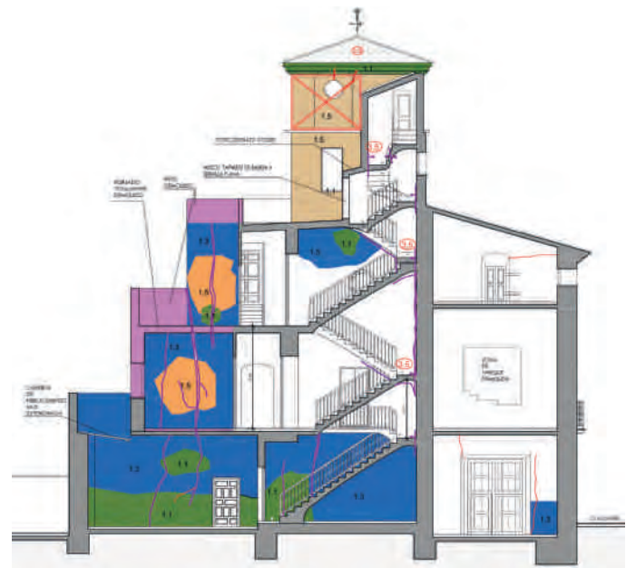
Figura 5. Sección por escalera de servicio, con daños.
