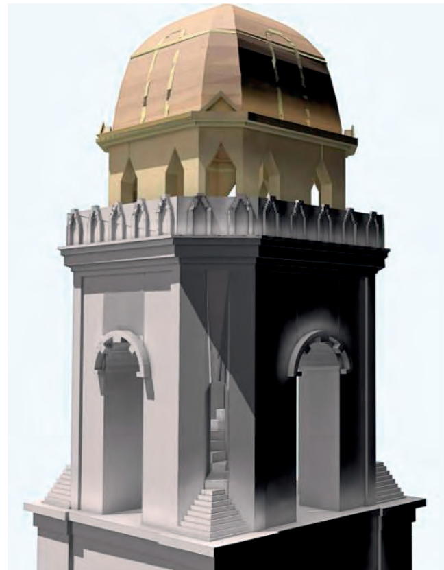
Figuras 39 y 40. Sección constructiva del nuevo remate de la torre y modelo 3D para estudiar el resultado final.
