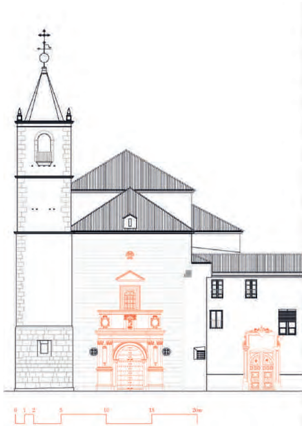
Figura 6. Alzado principal de la iglesia, en su estado final tras las obras. Juan de Dios de la Hoz. Lavila Arquitectos.
