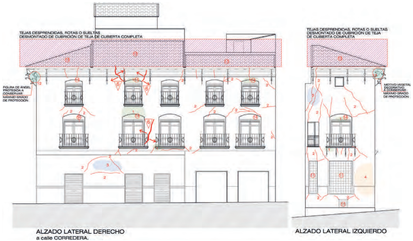
Figura 9. Fachadas laterales a calle Corredera y a casa Alcaraz, con descripción de los daños.
