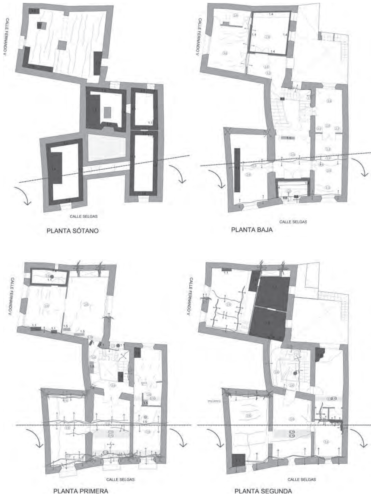
Figura 10. Plantas de daños en la edificación, tras el terremoto.
