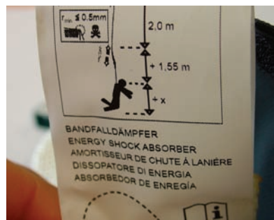
Imagen dcha. Etiquetado de un elemento de amarre con un absorbedor de energía: el fabricante especifica una apertura total del absorbedor de 1,55 m.
