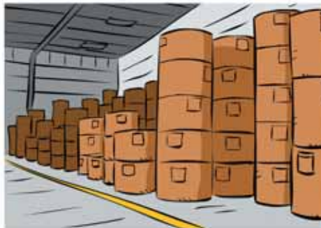
Almacenamiento de bobinas de papel (las alturas estarán comprendidas entre los 3 y los 7,4 m)
