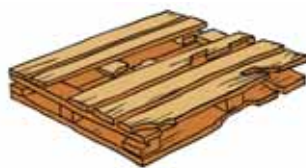
Daños en la base de una paleta que hacen que su reutilización sea inaceptable
