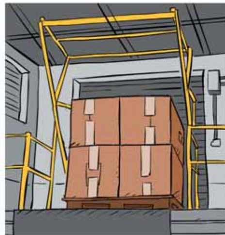
Sistemas de protección colectiva en zonas de recepción situadas en alturas superiores a 2 m
