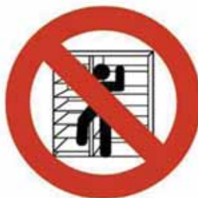
Señal de prohibido trepar por las estanterías
