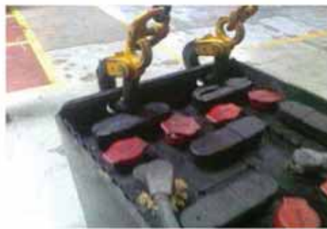
Manipulación de baterías con aparatos elevación
