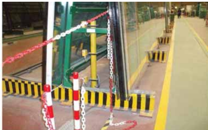
Señalización de la base de los caballetes y delimitación de zonas de paso
