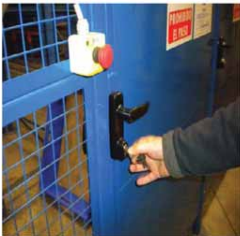
Sistema de control secuencial de desconexión en cuadro y acceso con llave única
