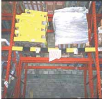
Debe evitarse almacenar materiales encima de los distanciadores de pasillo
