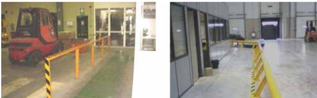
Ejemplos de protección de trabajadores que acceden a zonas de circulación de carretillas
