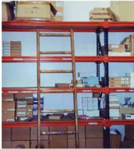
Medio de acceso no seguro para transportar o retirar productos voluminosos o pesados de niveles elevados
