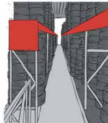
Altura máxima en almacenamiento en estanterías 4,4 m
