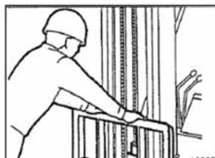
El respaldo (deformación, grietas...)
