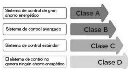
Figura 2. Clase energética del sistema de control y automatización
