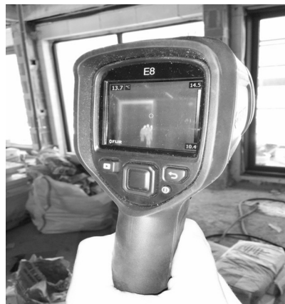
Figura 6. Imagen cámara termográfica
