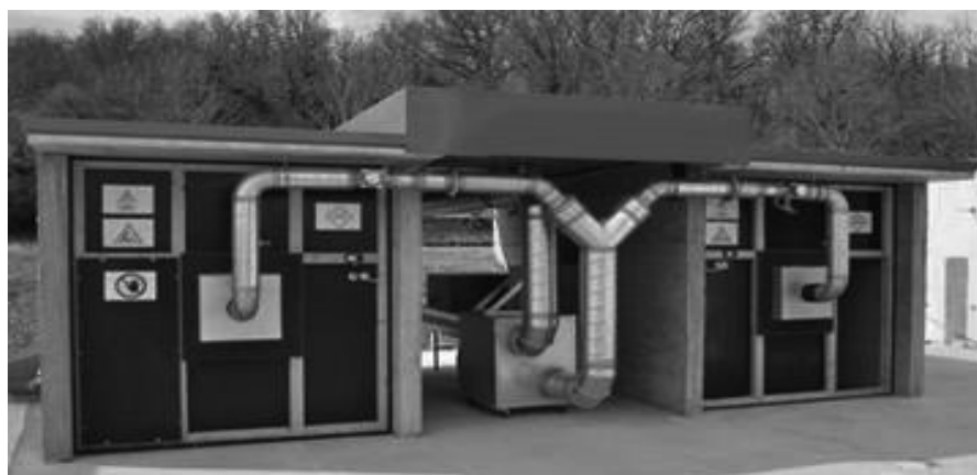
Figura 3. Fotografía de los garajes prototipo realizados para los test. A la derecha el de referencia y a la izquierda con las muestras Depolluting
