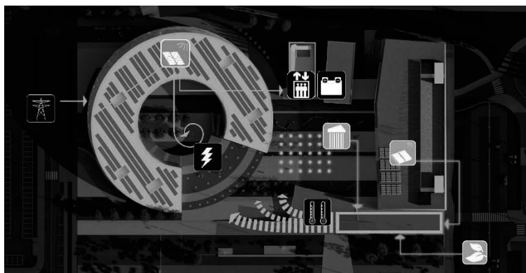
Figura 4. En azul origen y consumo de la energía eléctrica y en naranja origen de la energía térmica distribuida a través del District Heating-Cooling
