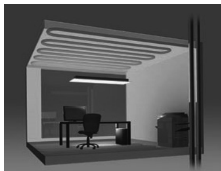
Figura 5. Enfriamiento de la masa de hormigón
