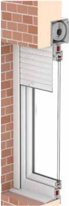
Figura 78. Detalle cajón de persiana compacto
