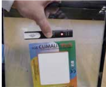
Figura 159. Dispositivo para identificación de vidrio de capas
