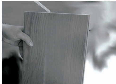
Figura 60 Aplicación de cola en la testa de la lama. Fuente: AIDIMA (2010).
