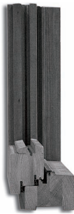
Figura 26 Detalle del perfil de una ventana de madera laminada encolada. Fuente: AIDIMA (2010).
