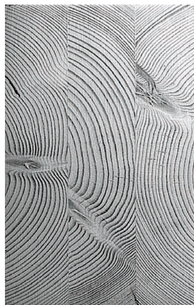
Figura 24a Madera laminada encolada vertical. Fuente: ProHolz.
