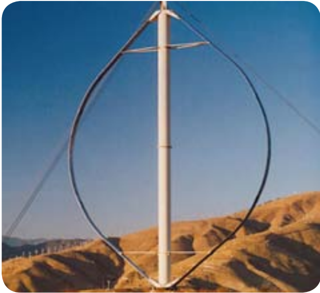
Aerogenerador de eje vertical (tipo Darrieus).
