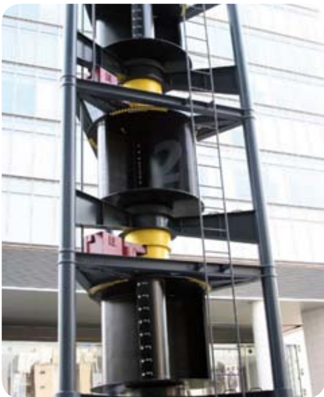
Aerogenerador de eje vertical (tipo Savonius).
