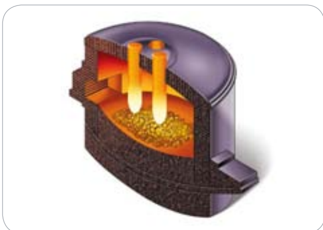
FIGURA 6 Esquema de un horno con electrodos.
