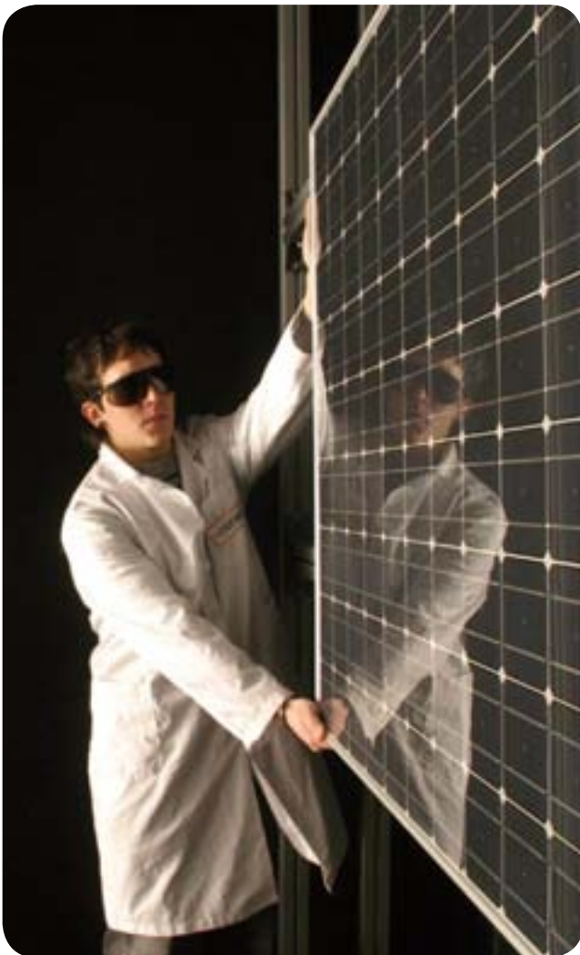
Prueba de ensayo de un módulo en el Simulador Solar Continuo.
