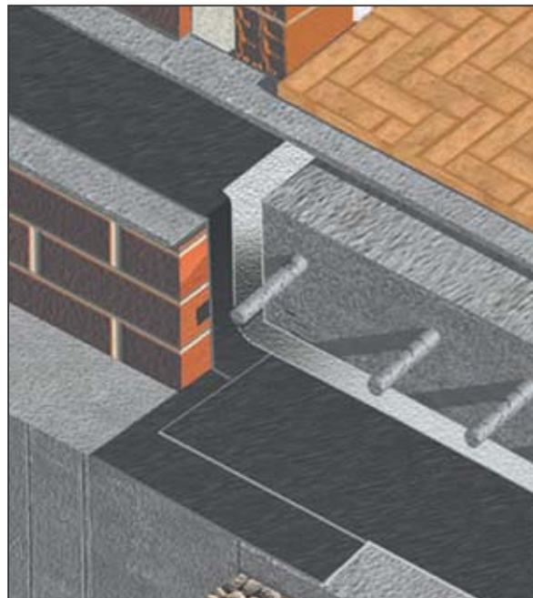
*Figura 4: Impermeabilización y barrera anticapilaridad en cimentación corrida con solera en contacto con el terreno*
