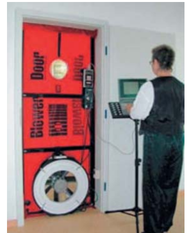
Fotografías 5 y 6. (izq.) El aislamiento es aún visible (planchas y paneles de madera): Este es el momento óptimo para una medición BlowerDoor. (dcha.) Estructura BlowerDoor instalada y lista para la búsqueda de infiltraciones.
