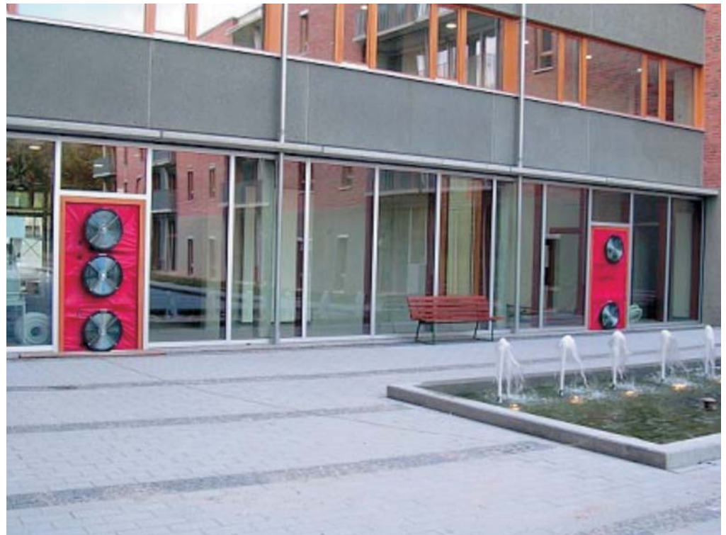
Fotografía 12. Test Blower Door en grandes edificios.
