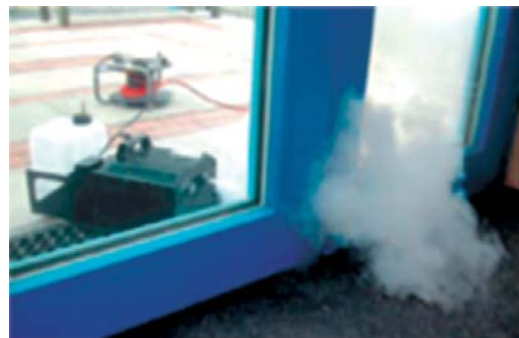
Fotografía 8. Generador de humo.
