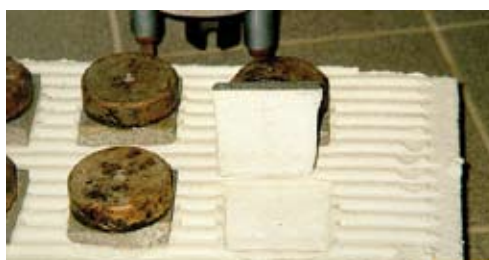
Rotura cohesiva en el adhesivo (ANFAPA) RC-A
