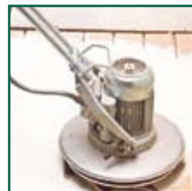
Rejuntado con máquina de disco rotatorio
