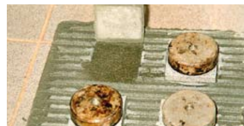
Rotura adhesiva adhesivo/soporte (ANFAPA) RA-S
