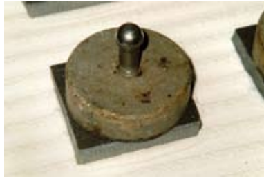
Plaqueta de 50x50 mm con la sufridera o cabezal de tracción adherido previo al arranque (ANFAPA)
