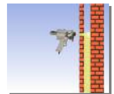
Poliuretano Inyectado
