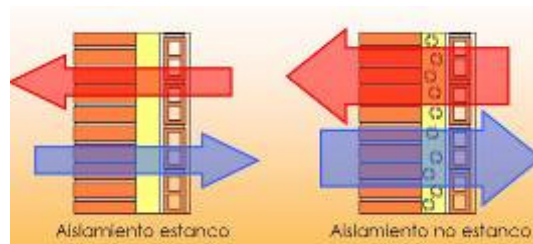
Disminución de la capacidad aislante por efecto de las infiltraciones de aire.
