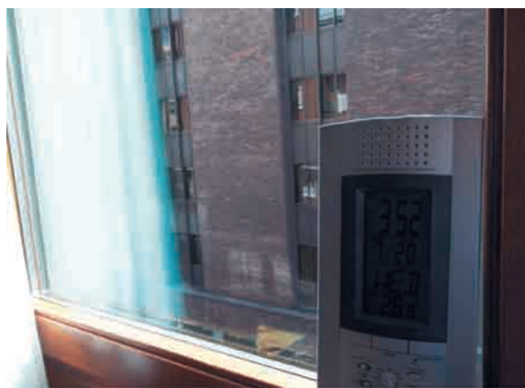
Foto 6. Temperatura en un local acristalado con UVA con protección solar ( g=0,42 ). Fuente: cedida por ANDIMAT.
