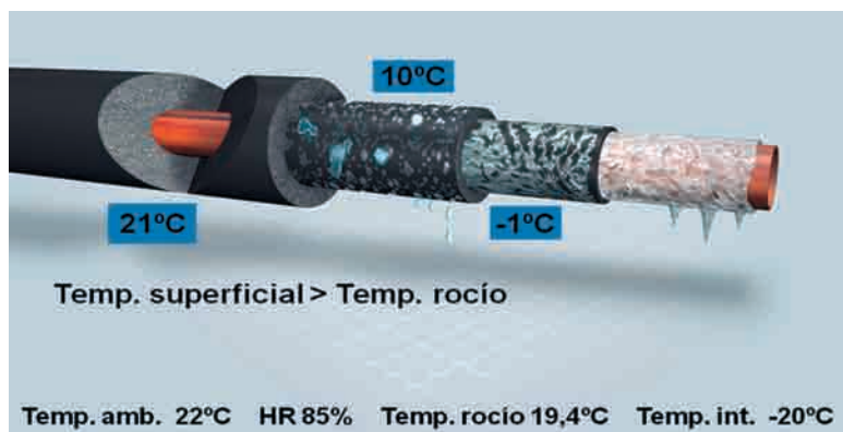
Figura 7. Tubería a baja temperatura con distintos espesores de aislamiento. Fuente: Armacell.
