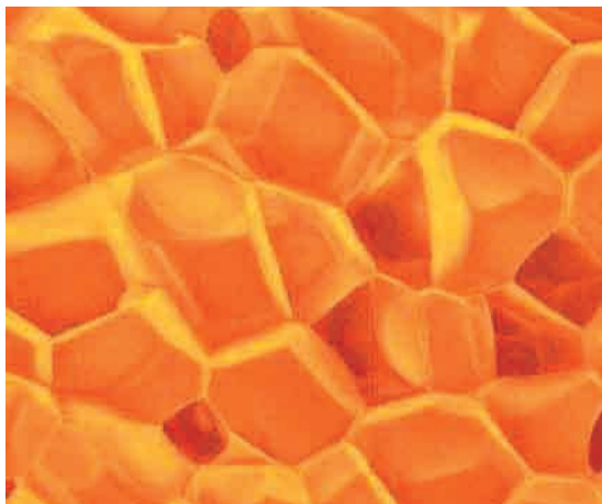
Figura 2. Estructura microscópica del (XPS). Fuente: URSA.
