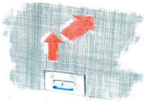
Figura 26. Detalle la instalación de la malla de armadura. Fuente: Guía IDAE: Sistemas de Aislamiento Térmico por el exterior (SATE) para la Rehabilitación de la Envolvente Térmica de los Edificios.
