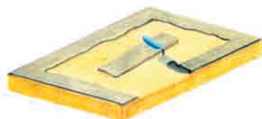
Pegado borde-punto en una plancha de MW. Además del adhesivo se debe reforzar con unas fijaciones mecánicas (p ej. Espigas)
