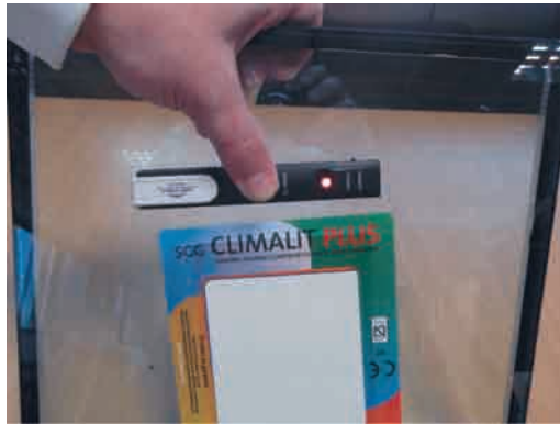
Foto 3. UVA de ATR con capa bajo emisiva y detector. Fuente: Fondo fotográfico SGG CLIMALIT PLUS
