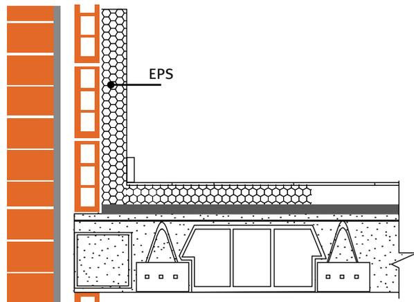
**Detalle 4:** Las medianeras entre viviendas deben mantener aislada una superficie de un metro desde la fachada para evitar este puente térmico.
