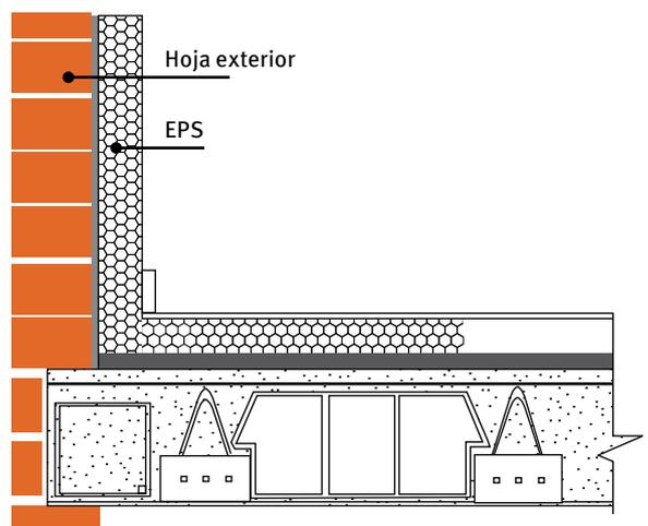
**Detalle 4:** Las medianeras entre viviendas deben mantener aislada una superficie de un metro desde la fachada para evitar este puente térmico.
