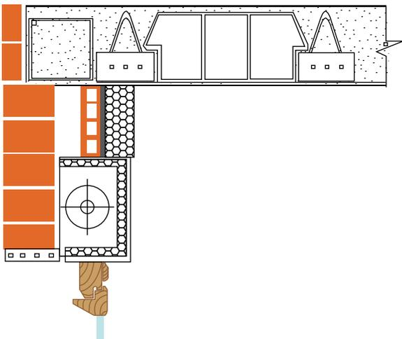
**Detalle 3:** Se recomienda colocar aislante bajo pavimento y rematar en el aislamiento de la fachada para evitar el puente térmico.
