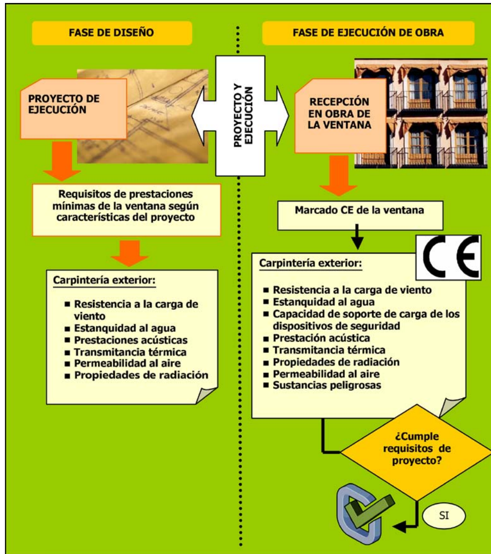
Figura 3. Marcado CE y CTE en ventanas
