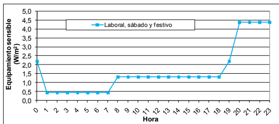
Imagen 3.7: Carga sensible viviendas equipos. Toda la potencia térmica aquí representada es sensible (no hay latente). Los valores umbrales son 4,4, 2,2, 1,32 y 0,44 W/m 2 .
